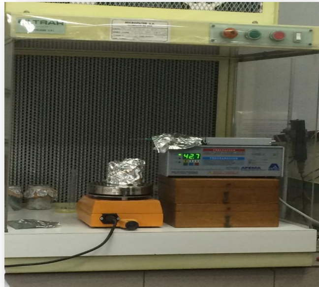
Figura 11. Equipo para la síntesis de las PECs. Inyector y agitador magnético en el flujo horizontal.
