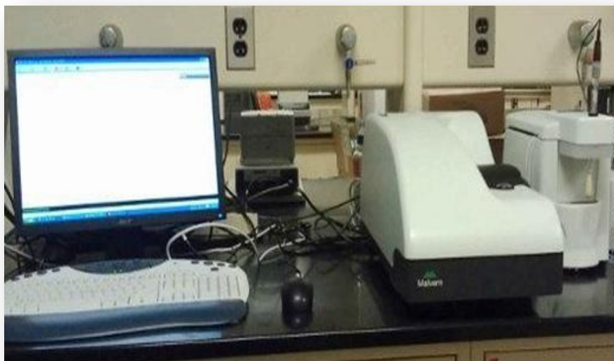
Figura 12. Equipo Zetasizer Nano ZS, con un láser He-Ne (633 nm) y un corrector digital ZEN3600
