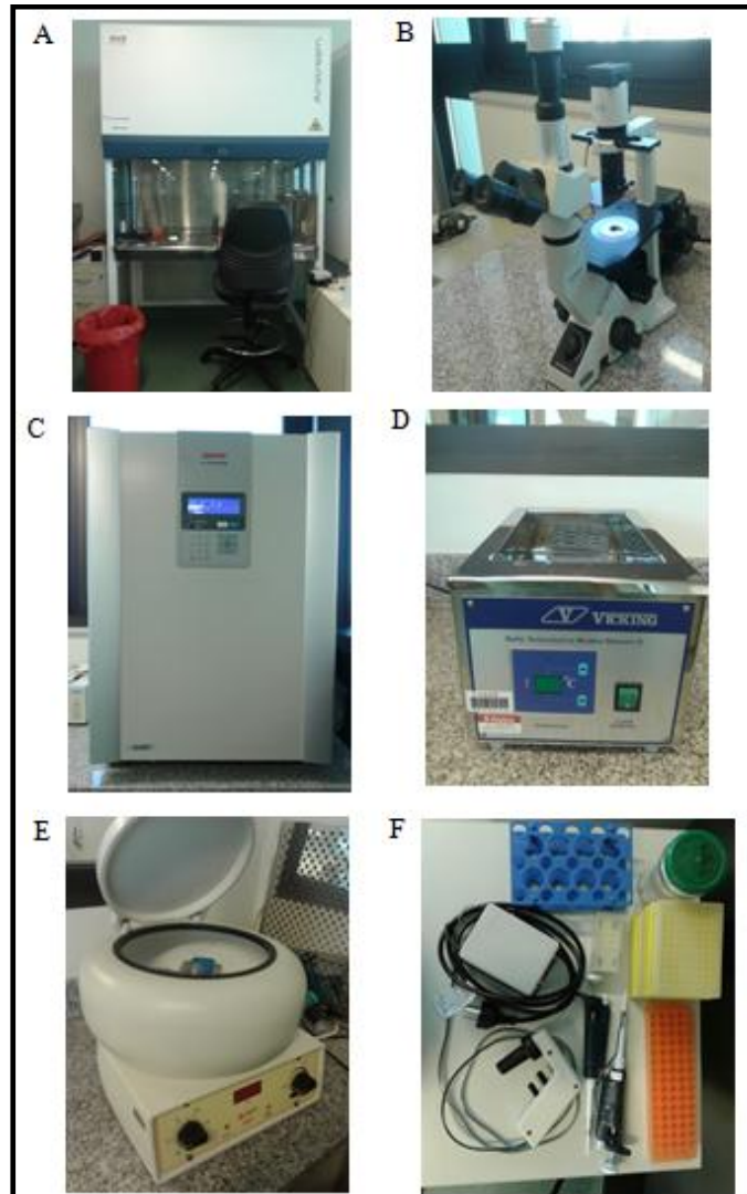
Figura 4. Elementos de trabajo del cuarto de cultivos. (A) Flujo laminar. (B) Microscopio invertido. (C) Estufa. (D) Baño termostático. (E) Centrifuga. (F) Elementos complementarios al trabajo de cultivos celulares, pipeteador automático, pipetas, tips, gradillas y eppendorf. (Fotografías tomadas en los UADE Labs).
