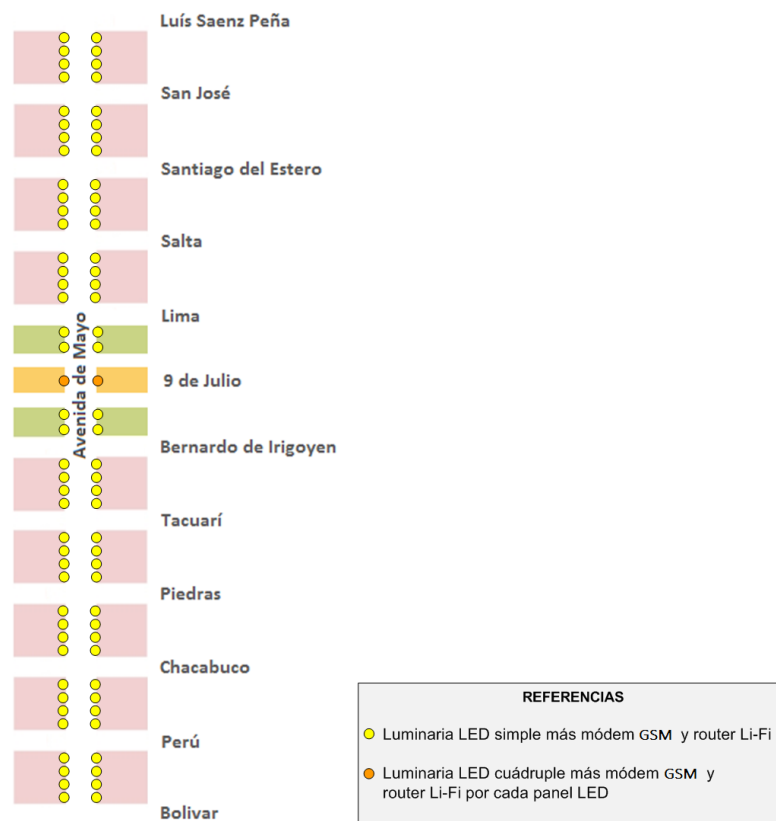
Figura 20: Gráfico del despliegue de la solución sobre Avenida de Mayo, Ciudad Autónoma de Buenos Aires
