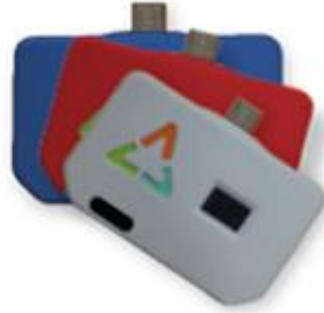
Figura 48: Dongle Li-Fi trans-receptor de OLEDComm 32
