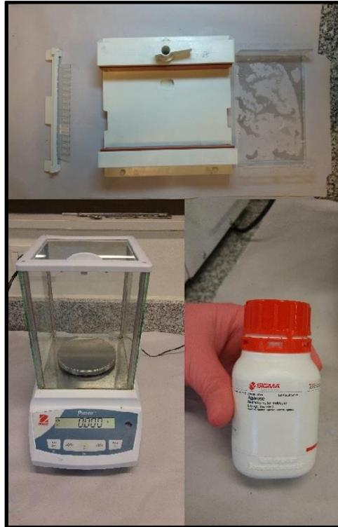
*Figura 12. Materiales utilizados para la preparación del Gel de Agarosa. Arriba, soporte, cama de acrílico y peine utilizados para el soporte físico del gel y la formación de calles. Abajo, balanza Pioneer y agarosa marca Sigma.*
