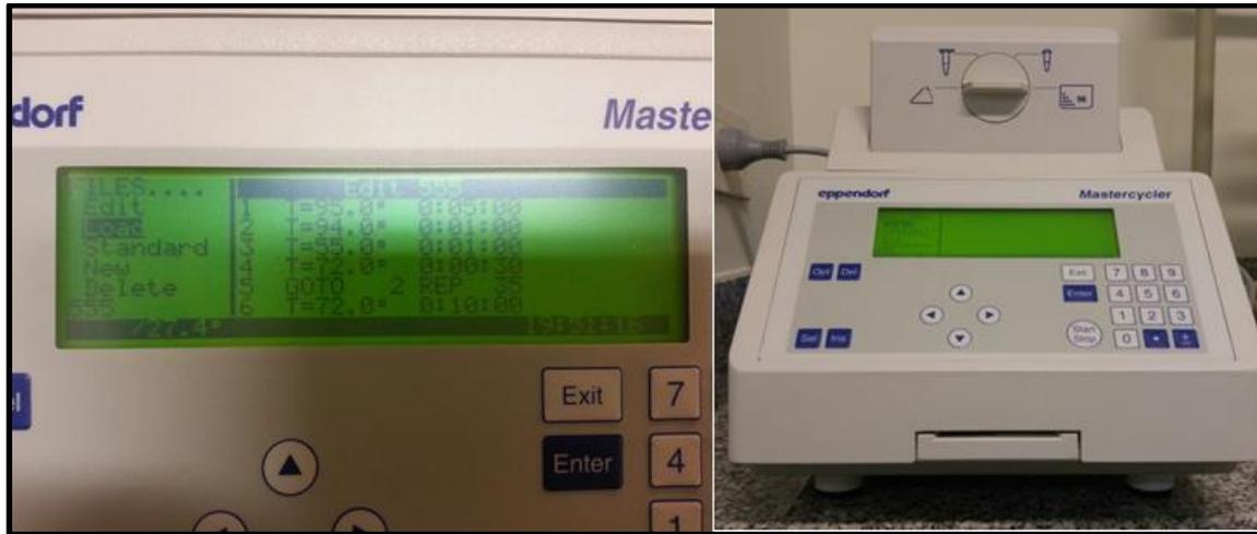
**Figura 11.** Termocicladora Mastercycler. A la izquierda, ciclos programados en la termocicladora; a derecha, imagen frontal del equipo.
