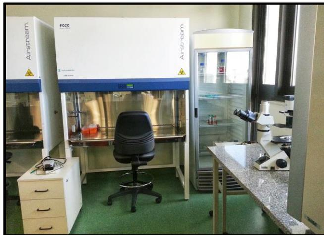
**Figura 6.** Laboratorio de cultivos celulares, 9no piso de los UADE Labs. Se observa el flujo laminar vertical utilizado y el microscopio de inversión a la derecha de la imagen.
