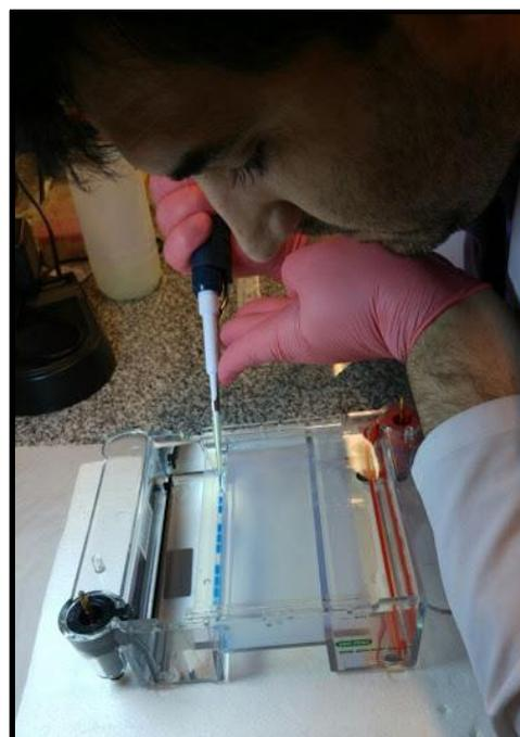
*Figura 13. Proceso de siembra de un gel de agarosa.*
