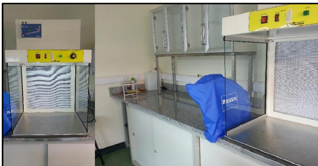
**Figura 10.** Cabina de flujo laminar utilizado en todo el desarrollo. A la izquierda, detalle de la Cabina de Flujo laminar. A la derecha, mesada de trabajo.
