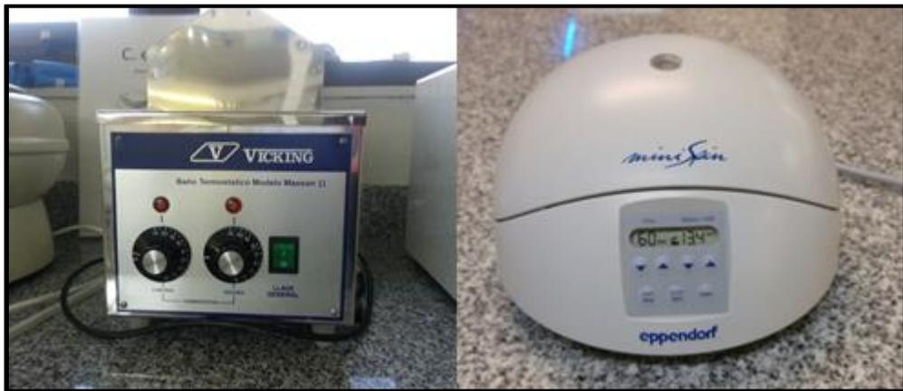
**Figura 9.** Equipamiento utilizado en el tratamiento de las muestras. A la izquierda, Baño termostático Vicking. A la derecha, microcentrífuga marca Eppendorf.
