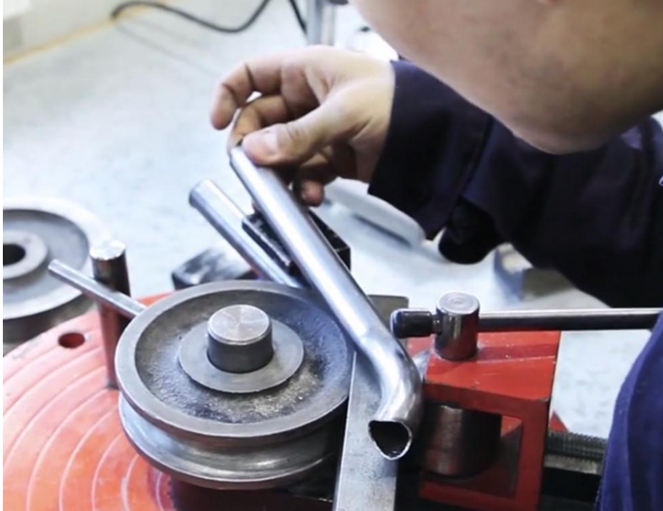
Midiendo, doblando y ajustando los caños metálicos.
