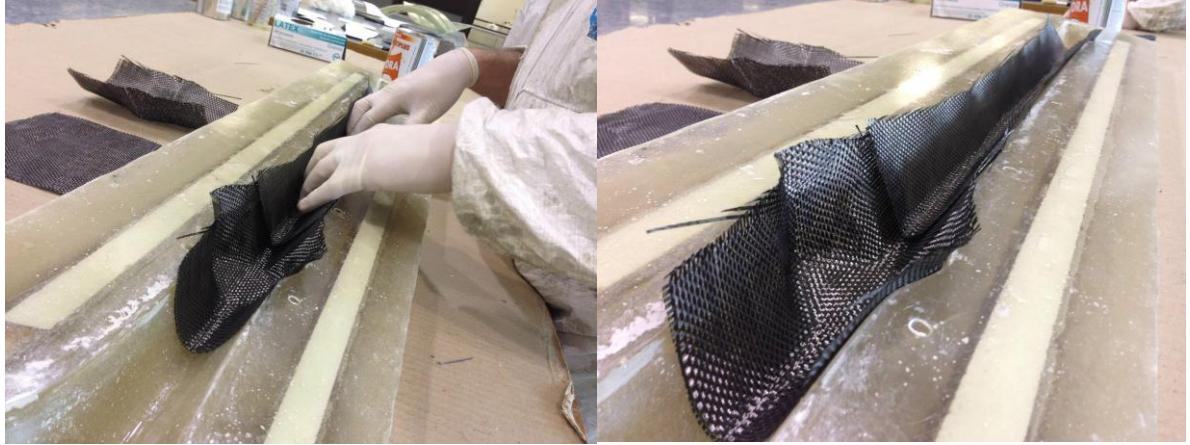
Colocación pieza por pieza dentro del molde
