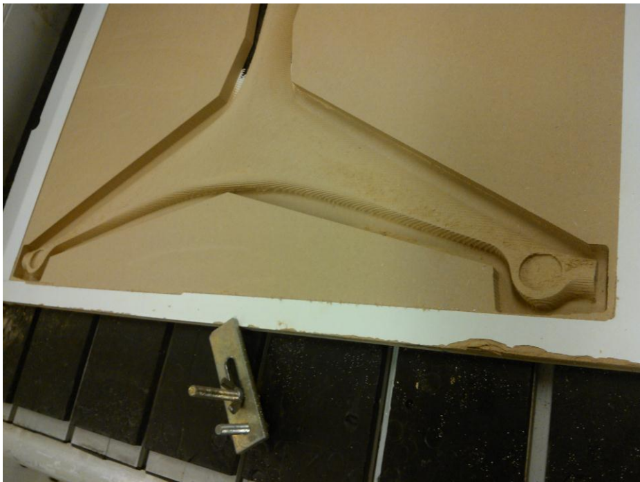
Fresando el cuerpo principal en MDF.
