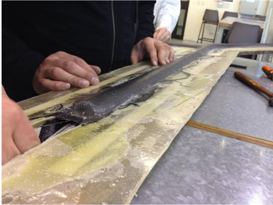
Desmoldando el cuadro principal.
