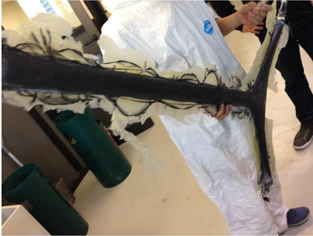
Desbarbando las piezas, ya que estas salen del molde con excedente de material.
