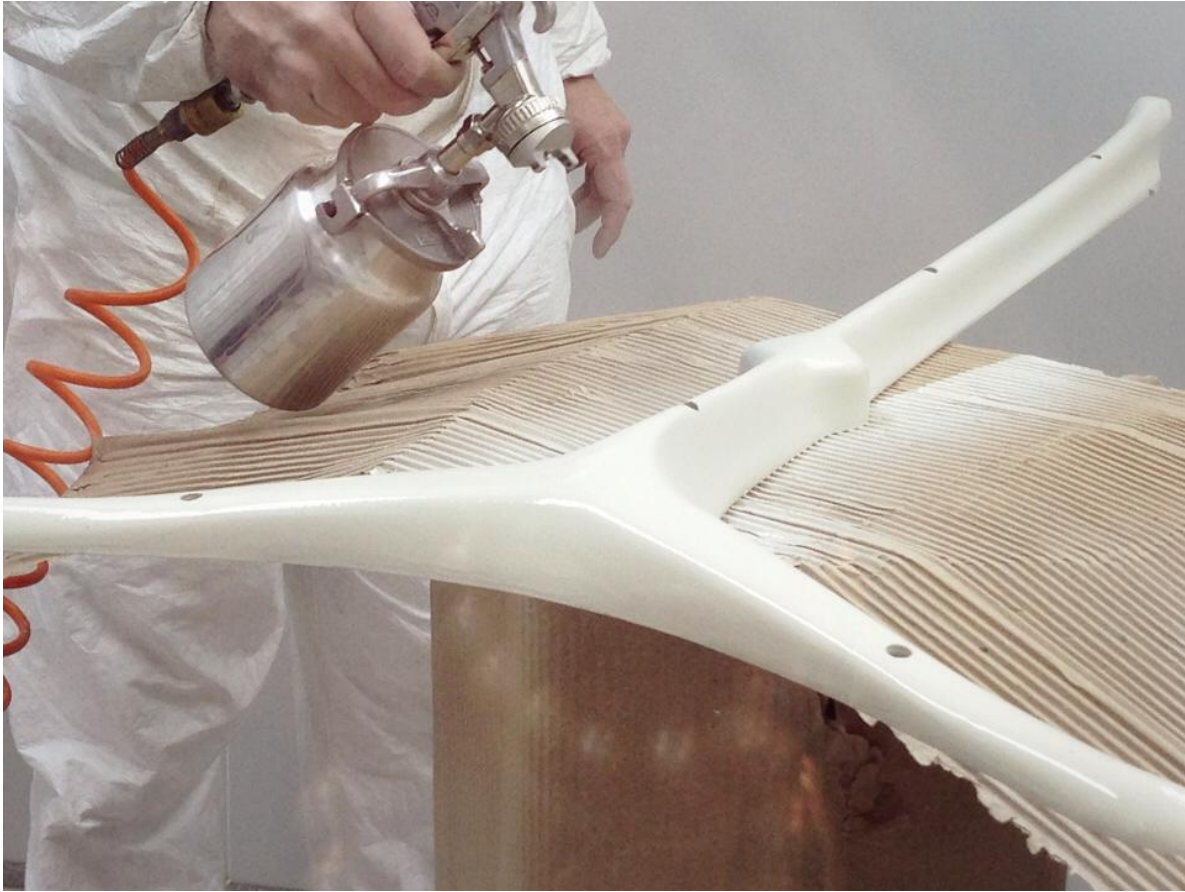
La capa de pintura garantiza un modelo sin detalles de terminación.
