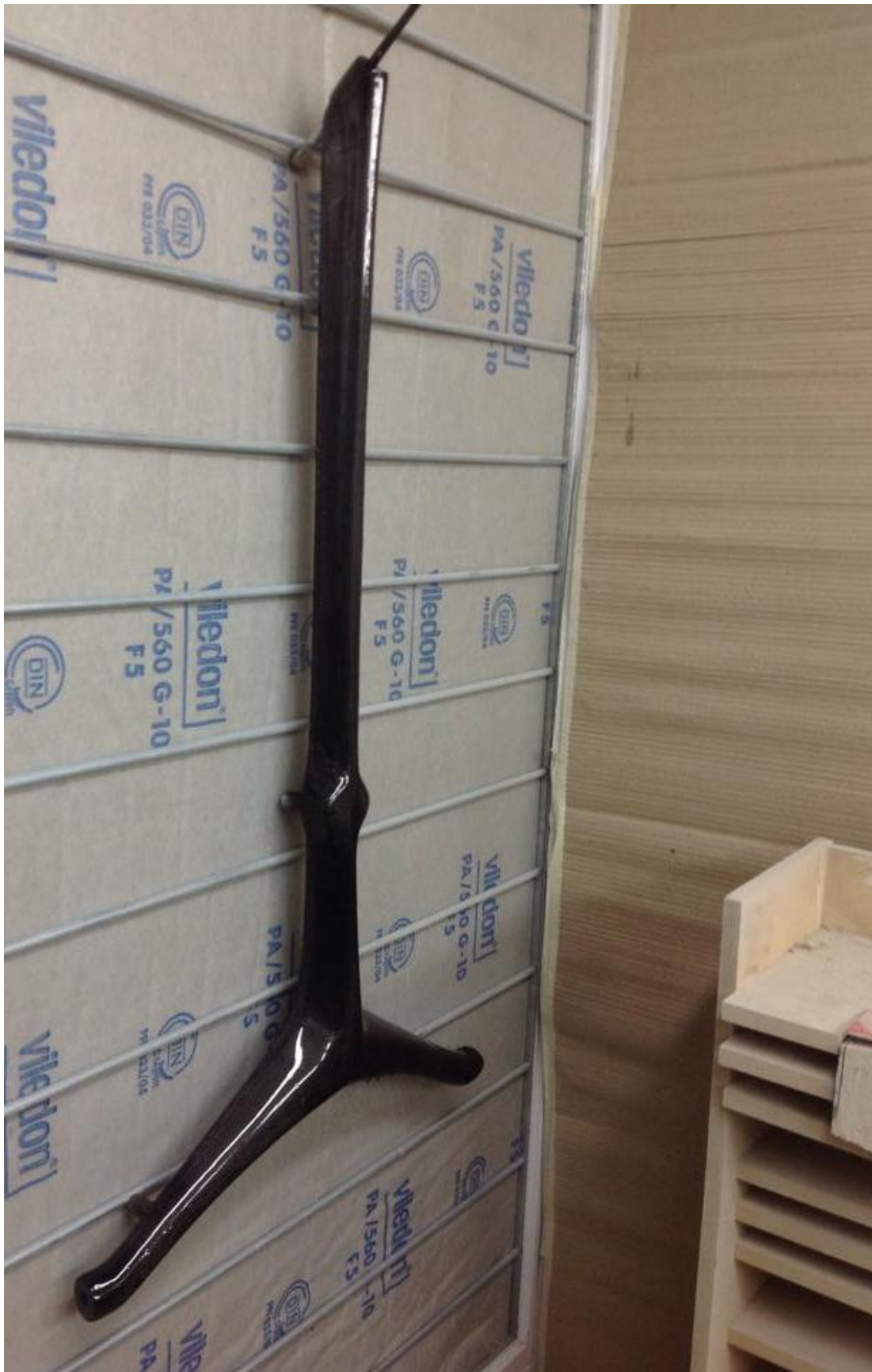
Pintado del cuadro en la cabina de pintura.
