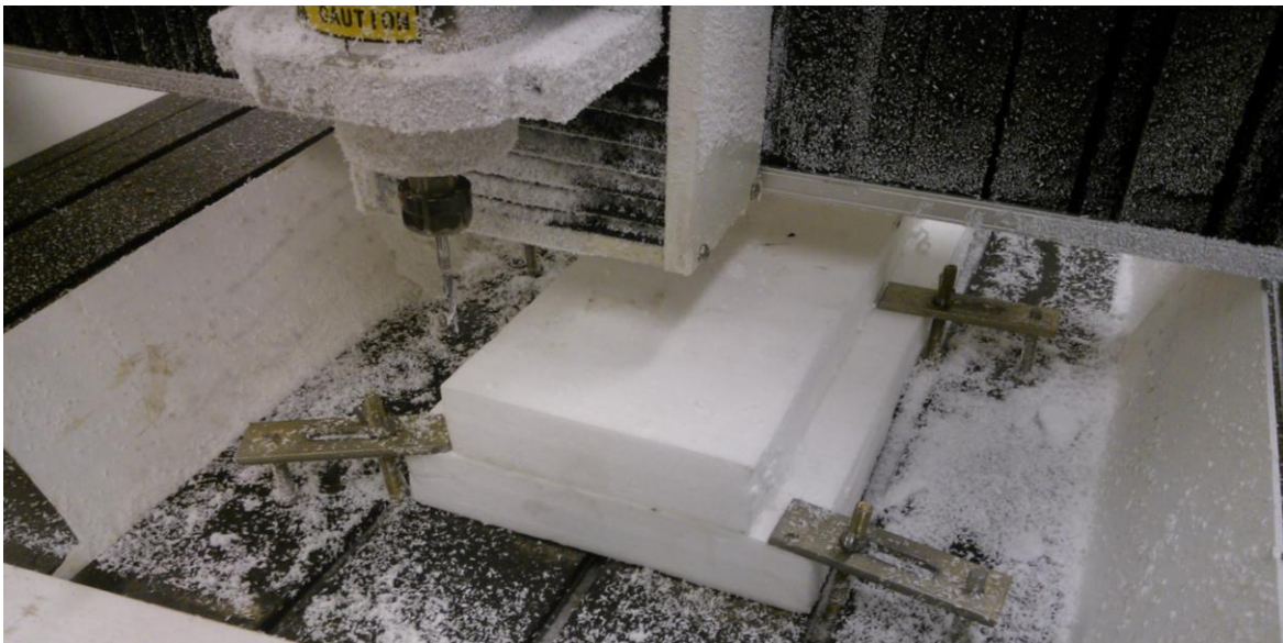
Fresando la horquilla en poliestireno expandido.
