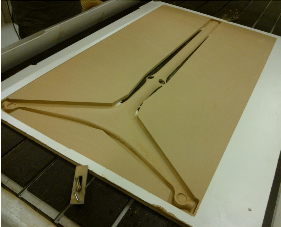
Finalización del fresado del cuerpo principal en MDF y poliestireno expandido.
