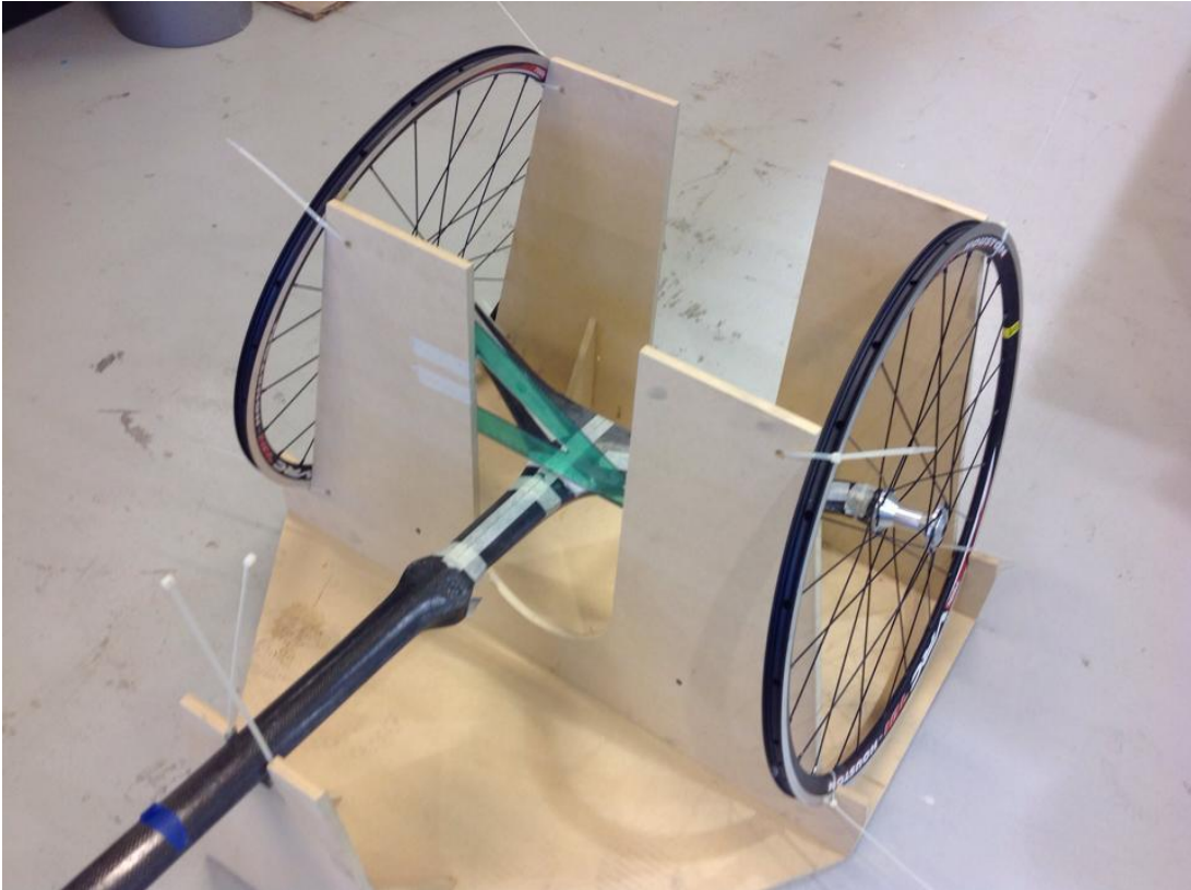
Dispositivo desarrollado para colocar y alinear correctamente las ruedas.
