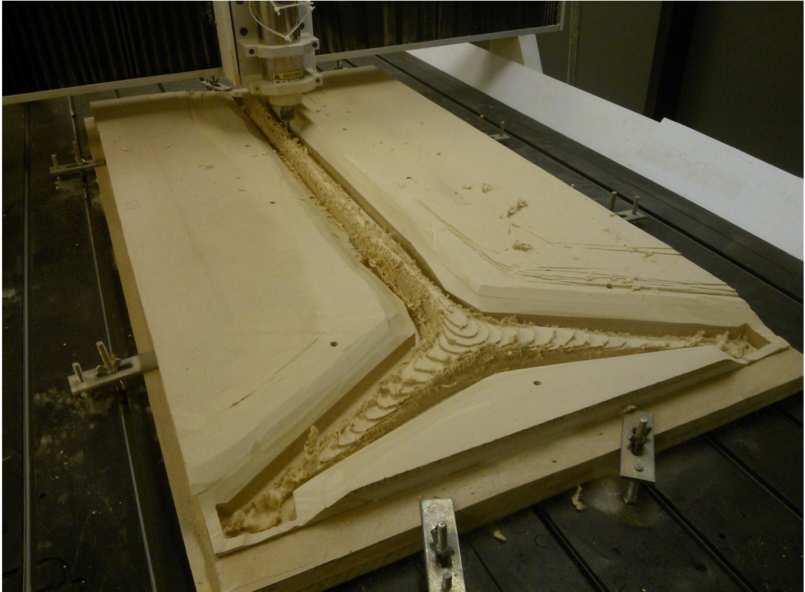
Fresando el cuerpo principal en MDF.
