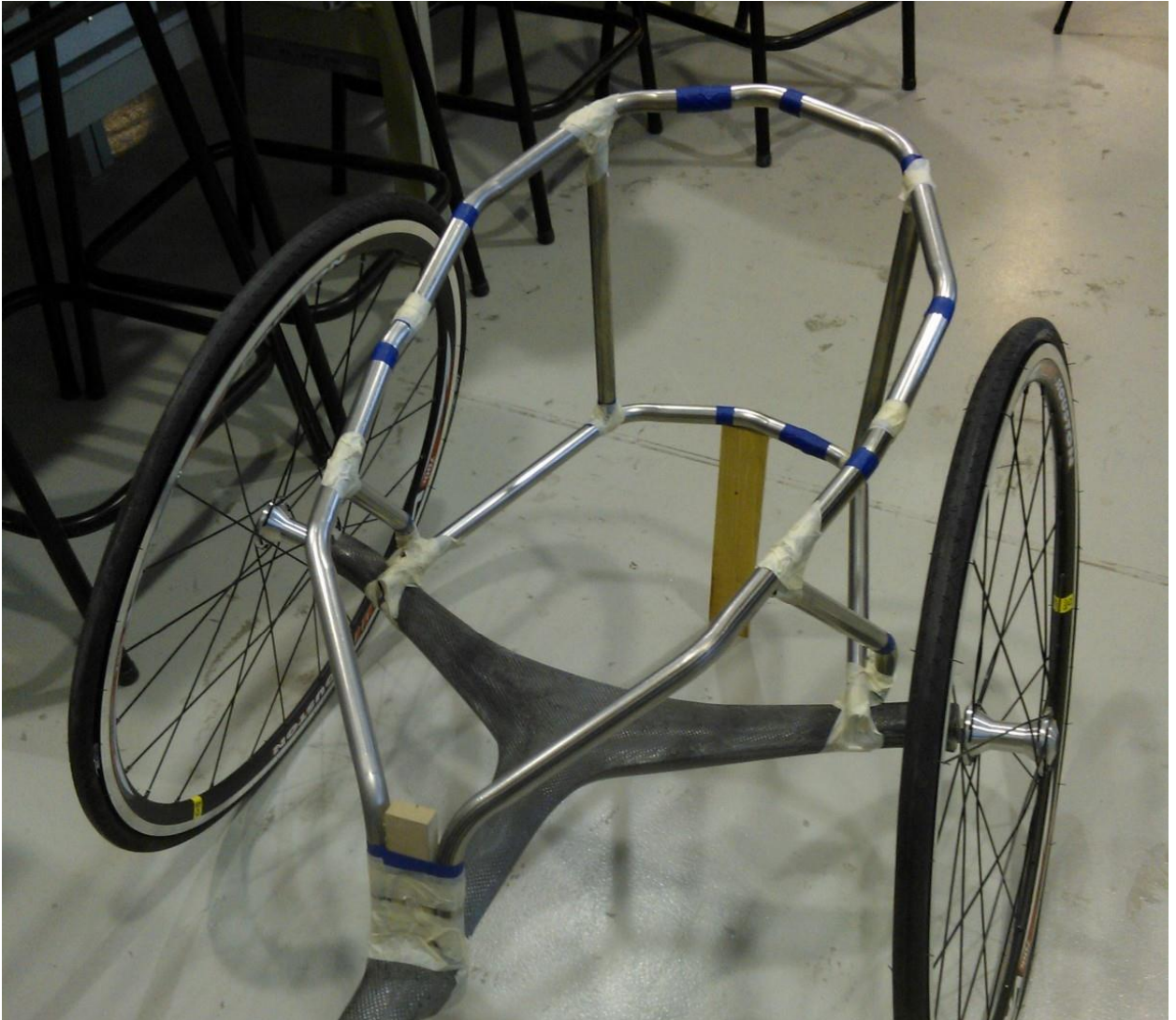
La estructura finalizada antes de soldarla.
