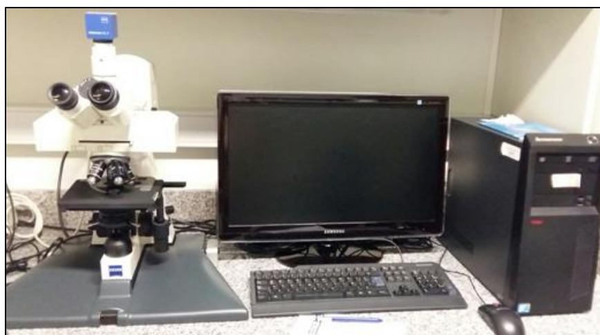
Figura 15. Instrumentos utilizados para tomar las fotografías de microscopía de fluorescencia. Esto consta de un microscopio de contraste de fases con cámara incorporada y computadora con el software correspondiente para el procesamiento de las imágenes obtenidas.
