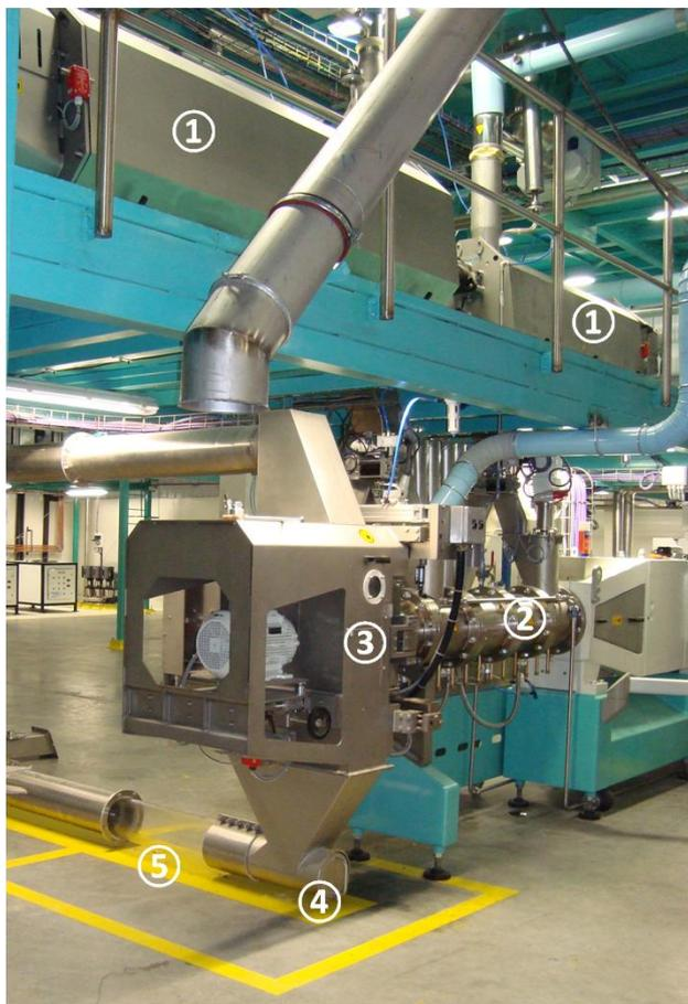
Figura 5: Equipos principales de producción de cereales extrusados. ①: Preacondicionador, ②: Extrusor, ③: Cuchilla, ④: Toma de muestra, ⑤: Visor.
