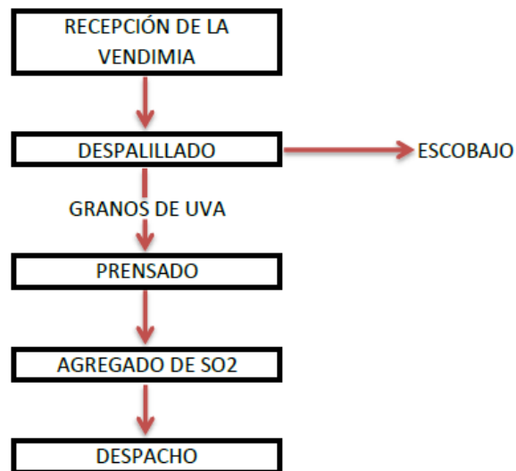
Figura 7: Diagrama de flujo para la fabricación de mosto sulfitado.
