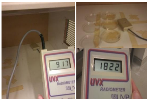
Figura 53 Distintas mediciones de intensidad de radiación UV-C en la caja utilizada para la validación de las lámparas de TUV8.
