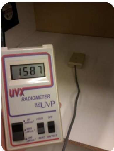
Figura 6 Medición de potencia de una de las esquinas de las cajas con UVX Radiometer UVP.
