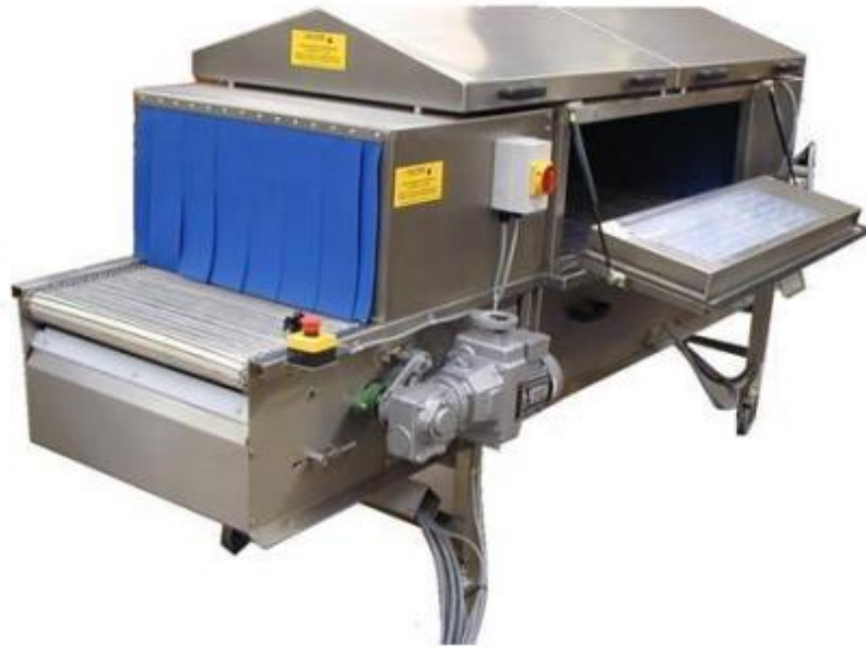
Figura 14 Túnel de descontaminación de Daro UV Systems LTD (Daro UV Systems LTD, 2010)
