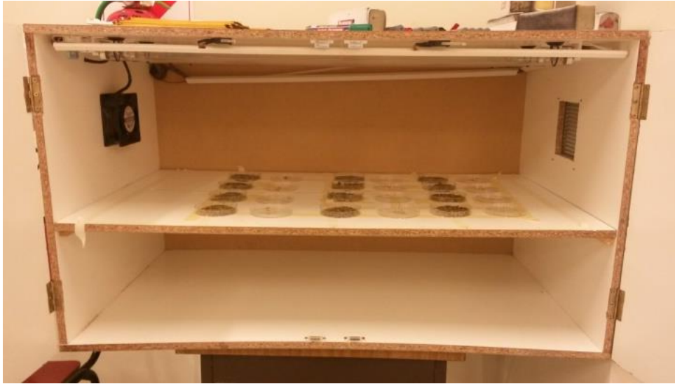
Figura 51 Caja UV ubicada en UADELabs Las muestras fueron expuestas a luz UV-C generada por 4 lámparas Phillips TUV8-T8 por un minuto.
