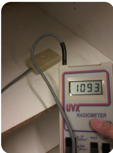
Figura 5 Medición de potencia de una de las esquinas de las cajas con UVX Radiometer UVP.
