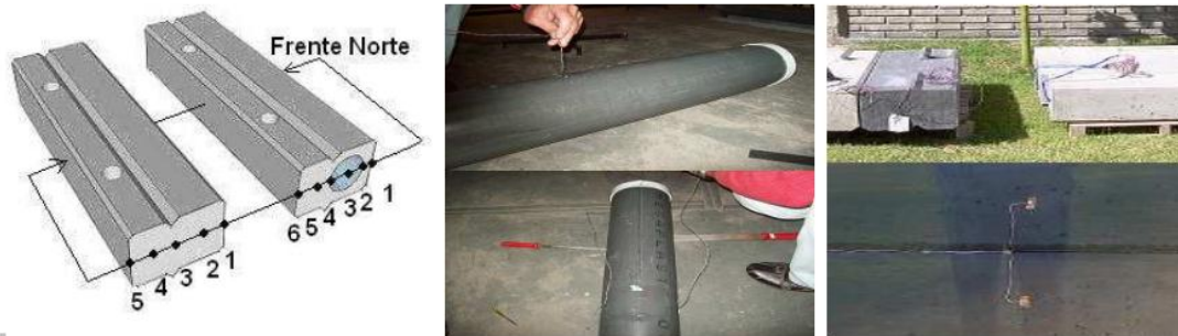
Figura 8: Colocación de termocuplas Cu-K en las piezas de acumulación de los MAC.
