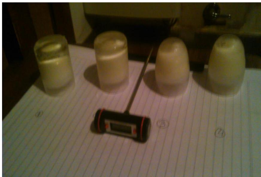
Figura 15: Ensayos realizados con 12cm<sup>3</sup> de aceite de coco en envases 3 y 4 expuestos a 24°C.
