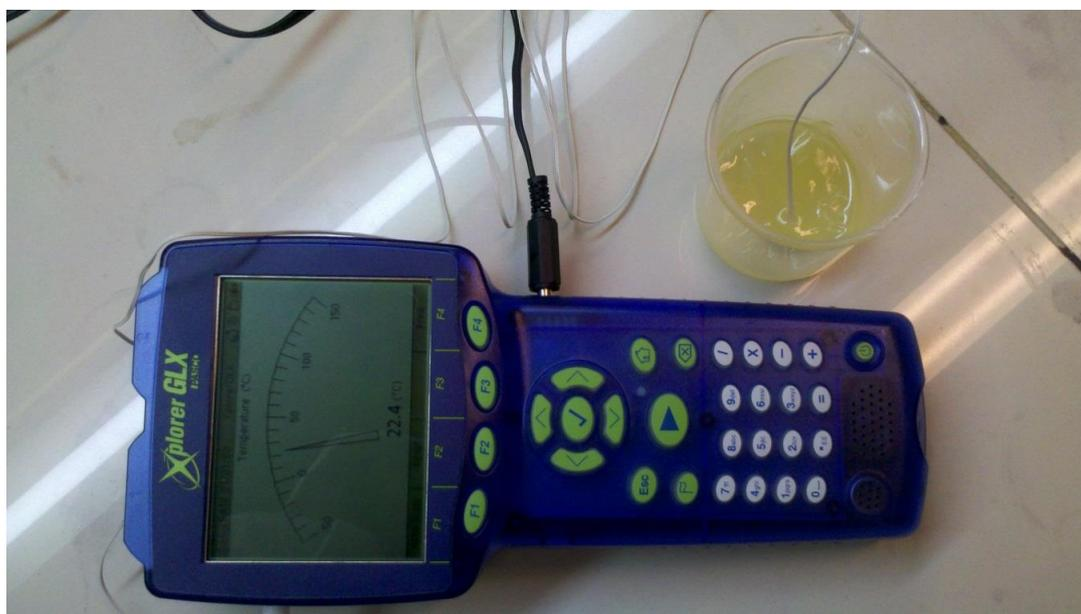
Figura 9: Medición de la temperatura en el seno de la mezcla (70-30%) con termómetro digital.
