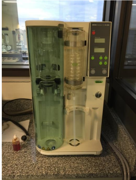
Figura 14: Destilador de laboratorio, Equipo semiautomático Buchi.
