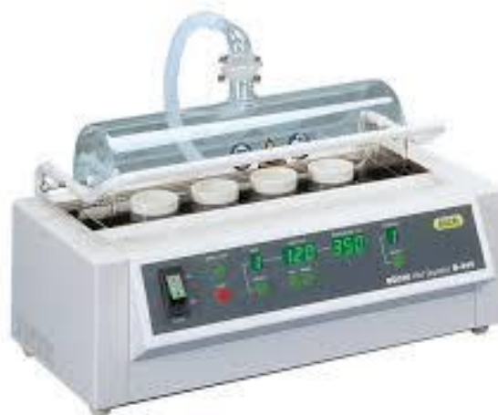
Figura 13: Digestor de laboratorio, equipo semiautomático Buchi.
