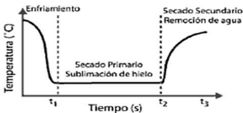
Figura 1: Pasos del proceso de liofilización, Fuente: Liofilización de alimentos, J.S Ramírez Navas 2006
