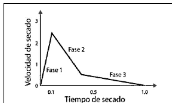
Figura 4: Fases de la etapa de secado, Fuente: Congelación y Liofilización de alimentos, C.E Orrego Alzate.
