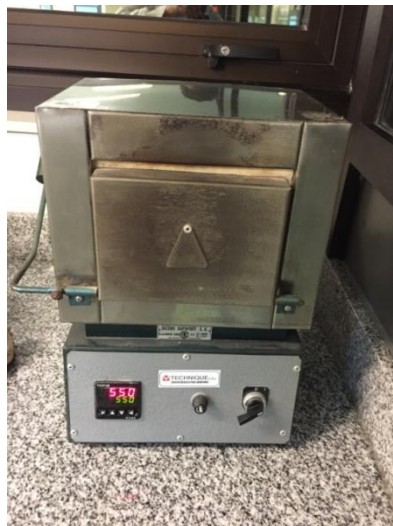
Figura 19: Experiencia de laboratorio, muestras llevada a mufla.
