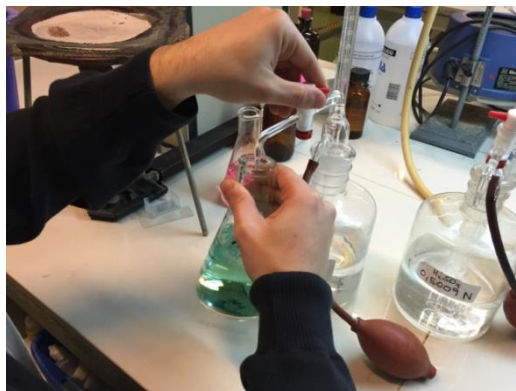
Figura 15: Experiencia de laboratorio, titulación de muestras
