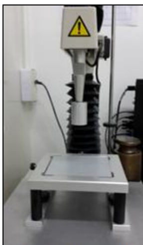
Fig. 25. Texturometro TA.XT plus
