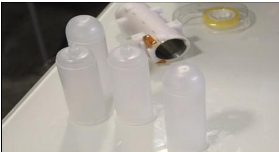
Fig. 15. Cápsulas plásticas de la impresora 3D Foodini.
