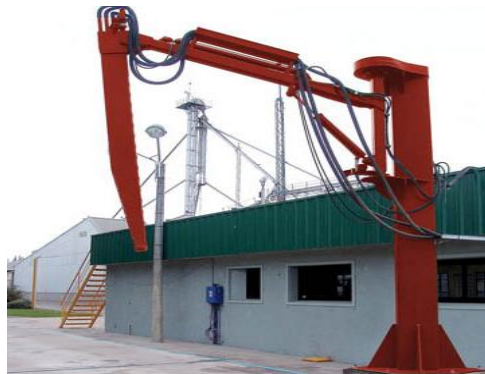
Figura 38. Calador hidráulico dispuesto al pie de la báscula.
