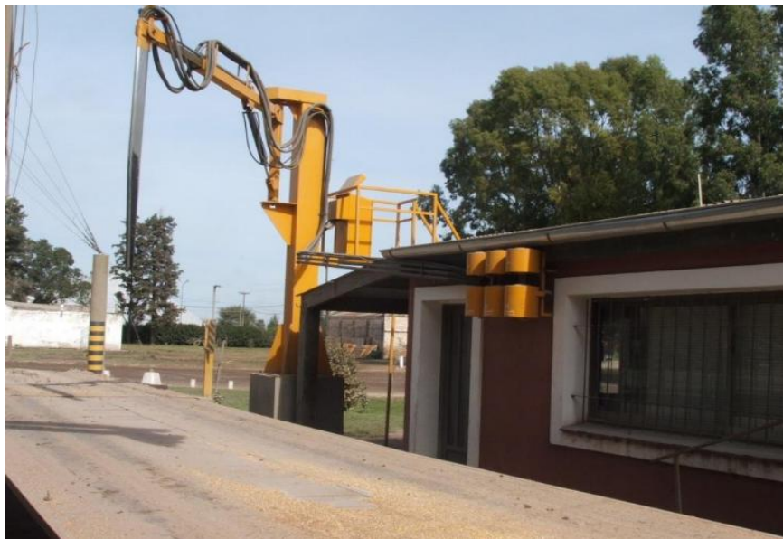
Fig.22. Calador con transporte de muestras neumático
