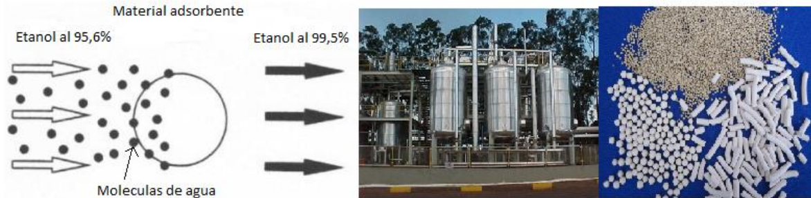
Fig.32 Adsorción de moléculas de agua y vista del exterior de tamices moleculares y zeolitas
