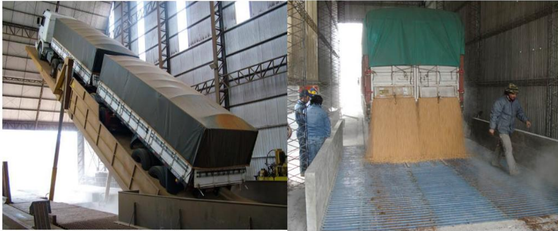
Figura 23. Descarga de cereal en fosa mediante plataforma volcadora hidráulica.
