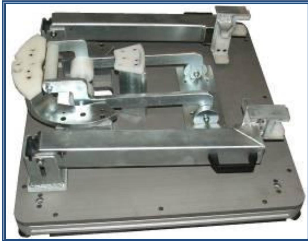
Ilustración 27 Placas de apoyo para armado de suspensión.
