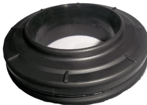
**Ilustración 15** Apoyo superior del amortiguador
