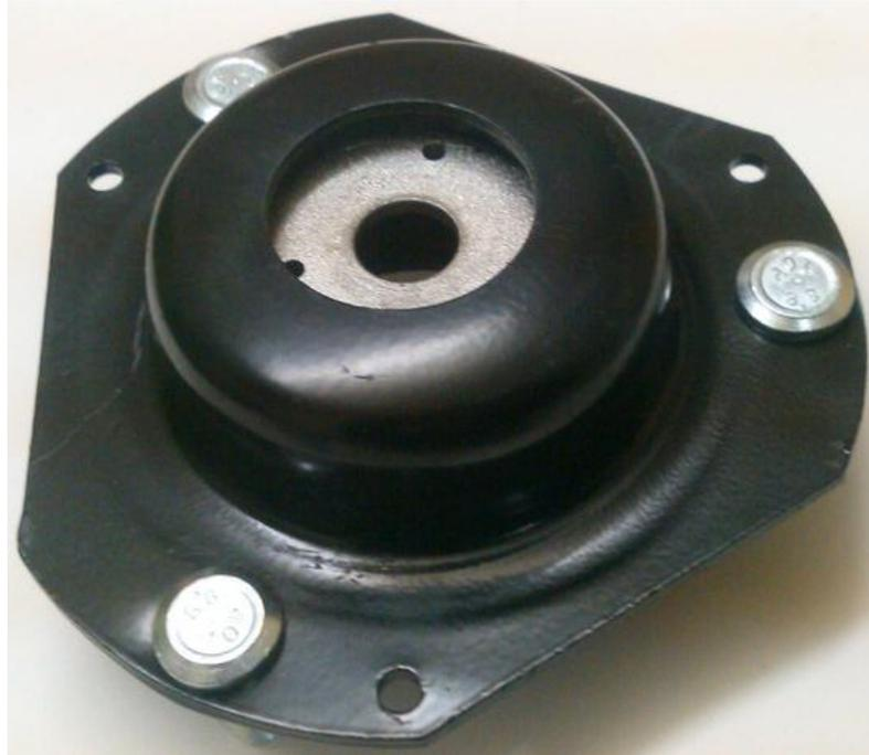
Ilustración 17 Rodamiento axial o cazoleta
