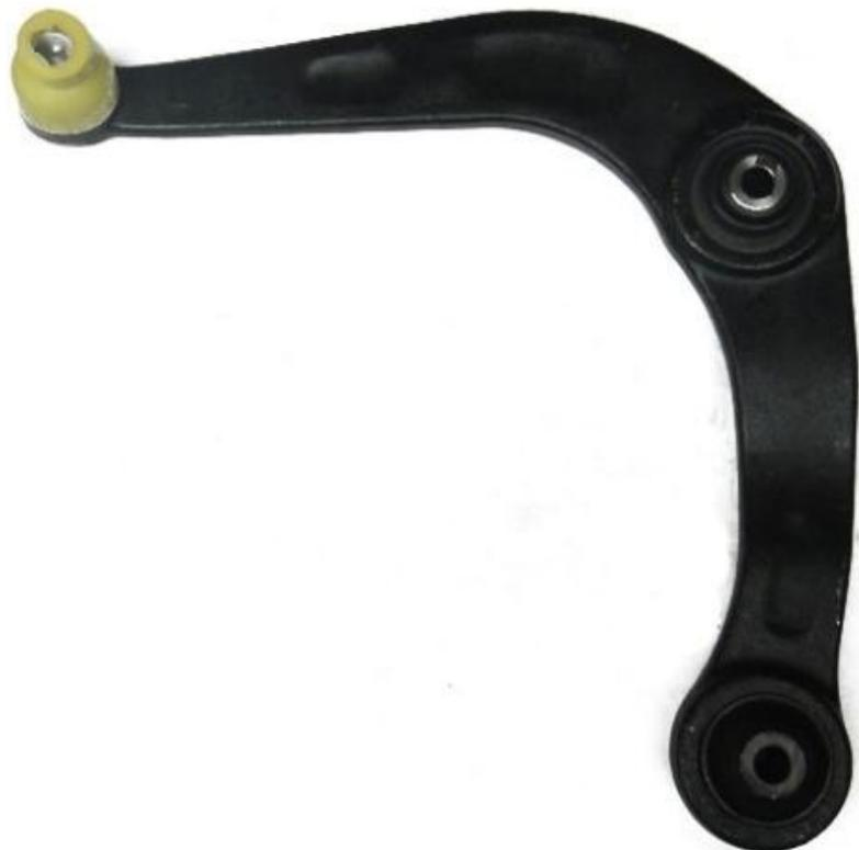
Ilustración 20- Brazo oscilante inferior o parrilla de suspensión en forma de boomerang
