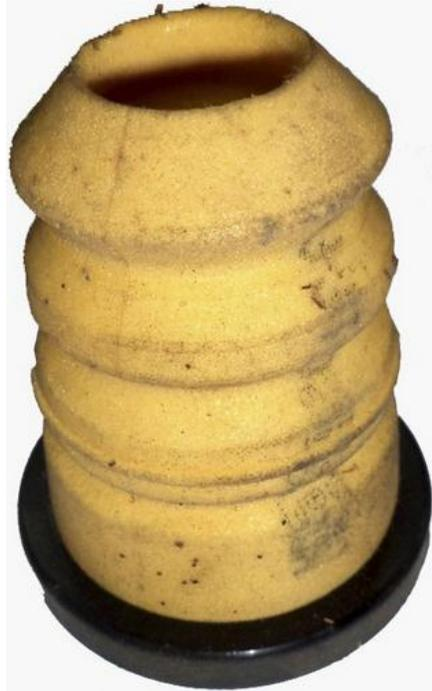
**Ilustración 16** Tope superior del amortiguador
