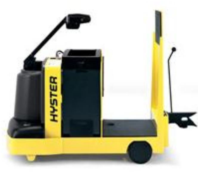
Ilustración 37 Tractora para movimiento de piezas
