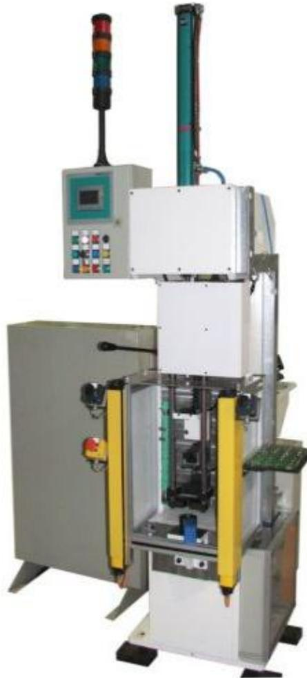
Ilustración 25 Prensa de la espiral de suspensión
