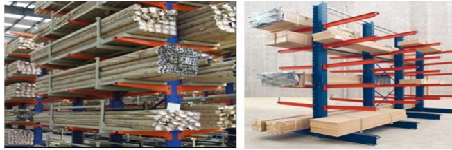
Figura 49: Almacenaje de producto terminado (Cantilever).
