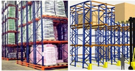
Figura 25: Racks selectivos de doble profundidad.
