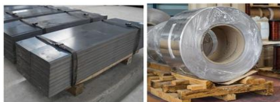
Figura 35: Planchas y bobinas de chapa palletizados.
