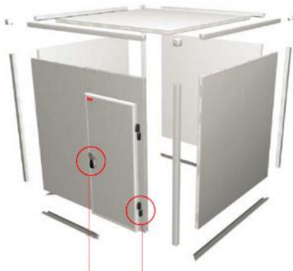
Figura 32: construcción de la cámara con paneles inyectados (fuente: Arneg Argentina)
