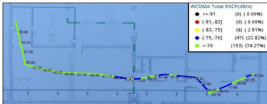
FIGURA 90: Walk test del cliente BAM SA, estado final RSCP. Planta baja.
