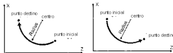
Figura 35. Izq. Arco sentido horario, Der. Arco sentido anti-horario
