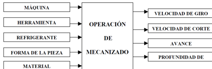
Figura 7. Características para una Operación de Mecanizado
