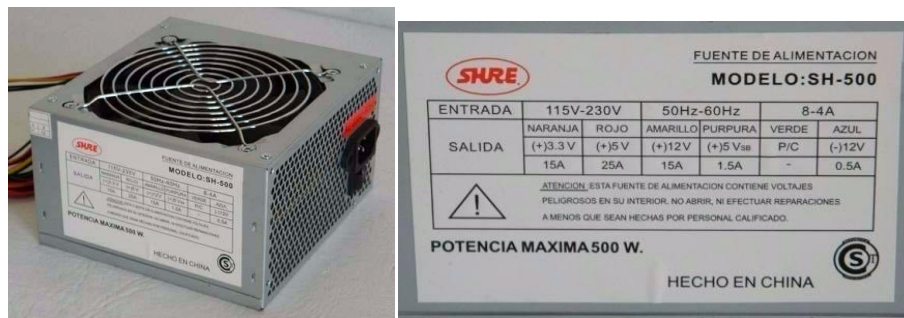
Figura 74. Fuente SHRE Modelo SH-500 de 500W
