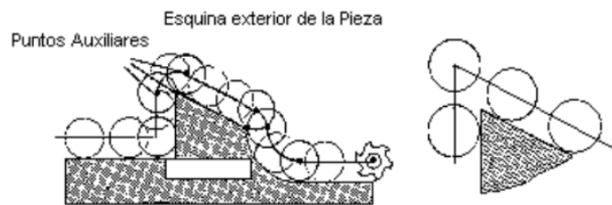
Figura 40. Cálculo de puntos auxiliares en trayectorias equidistantes
