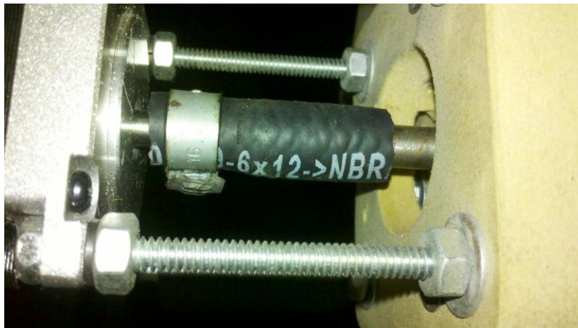
Figura 60. Acople de goma entre eje de motor y eje de transmisión utilizado en el proyecto
