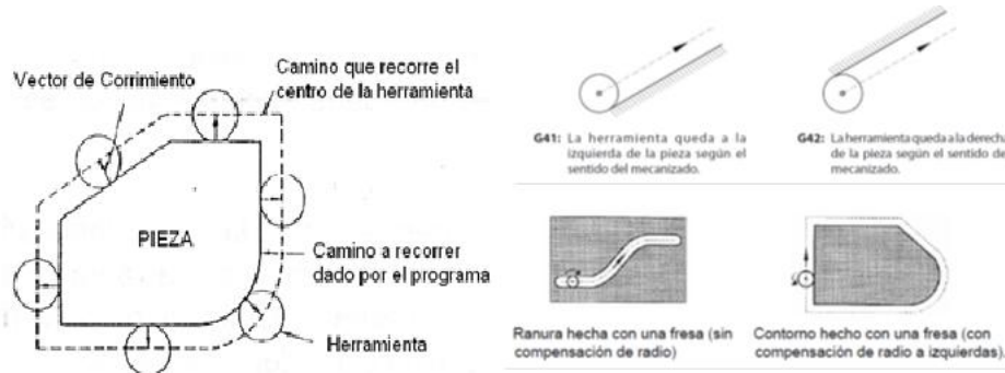
Figura 51. Compensación de la ruta de la herramienta
