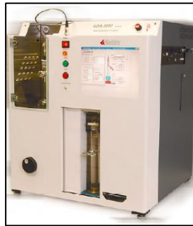
Figura 22: Equipo Método de Testeo ASTM D-86.
