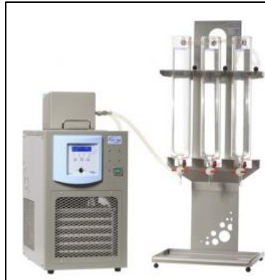
Figura 23: Equipo Método de Testeo ASTM D-1298.
