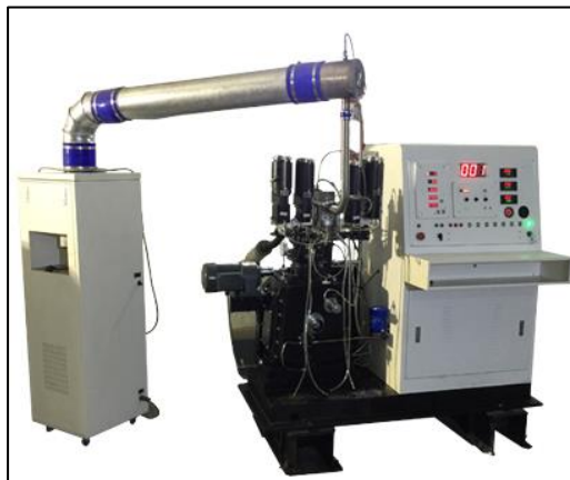
Figura 24: Equipo Método de Testeo ASTM D-2699/2700.
