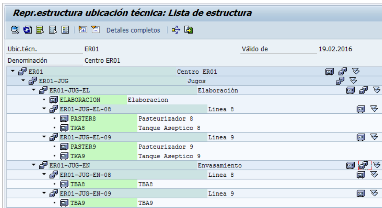
Figura 63: Estructura jerárquica de mantenimiento
