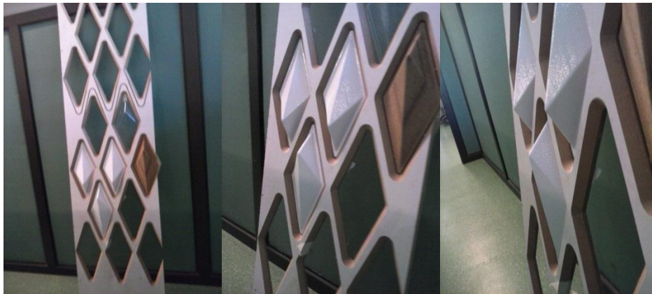
Pruebas de elementos verticales de routeado en MDF C/melanina.
