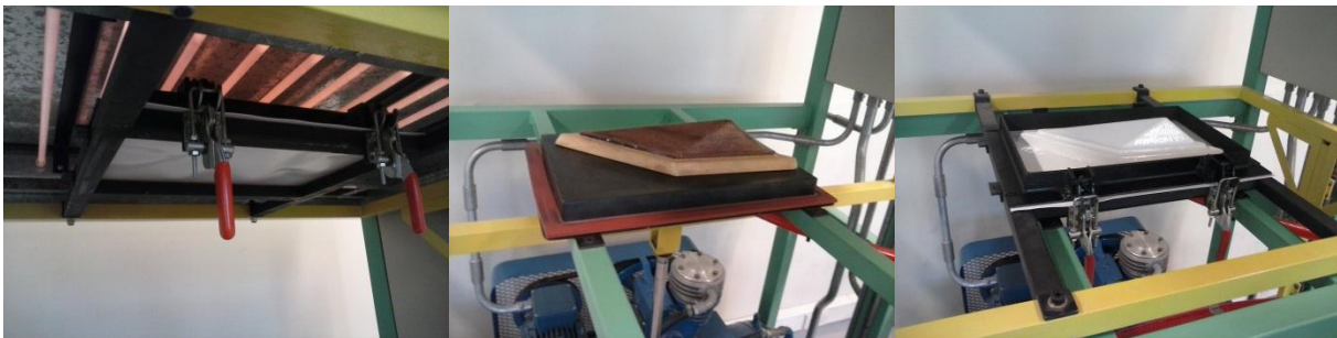
Pruebas de piezas routeadas en MDF termoformadas en Alto Impacto.
