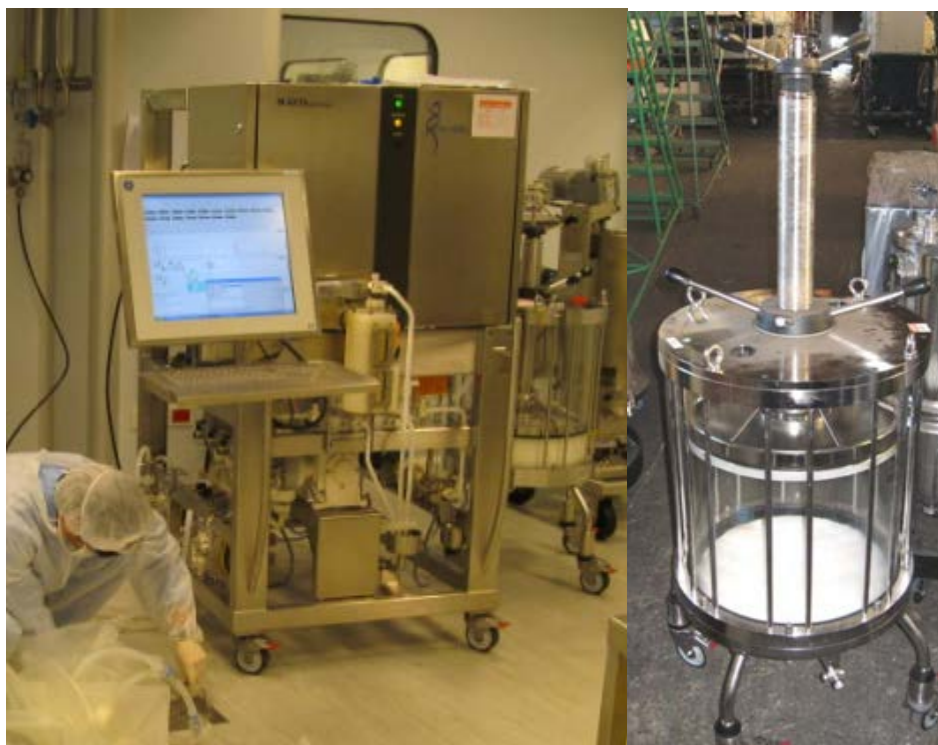
Figura 3. Cromatografía por proteína A
