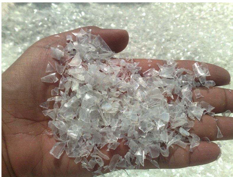
Imagen: Escamas de PET PCR (Post consumo reciclado), obtenidas como producto del proceso de reciclado.
