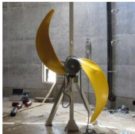
Imagen V: Post digestor, agitador de 15 hp – homogenizado de biofertilizante
