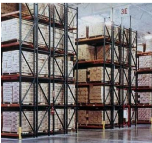
Figura 6 - Racks selectivos de doble profundidad
