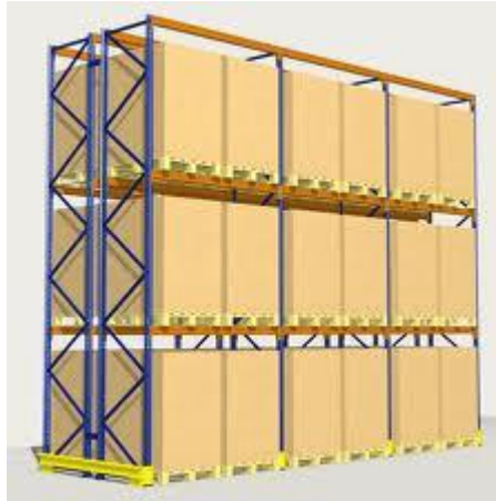
Figura 7: Racks metálicos selectivos
