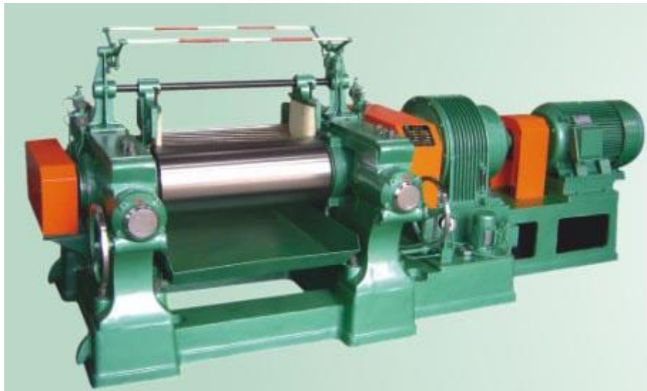
Figura 7: Mezcladora de caucho
