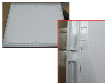
Figura 40: Grapas – ensamblado de grapa para tapa superior
