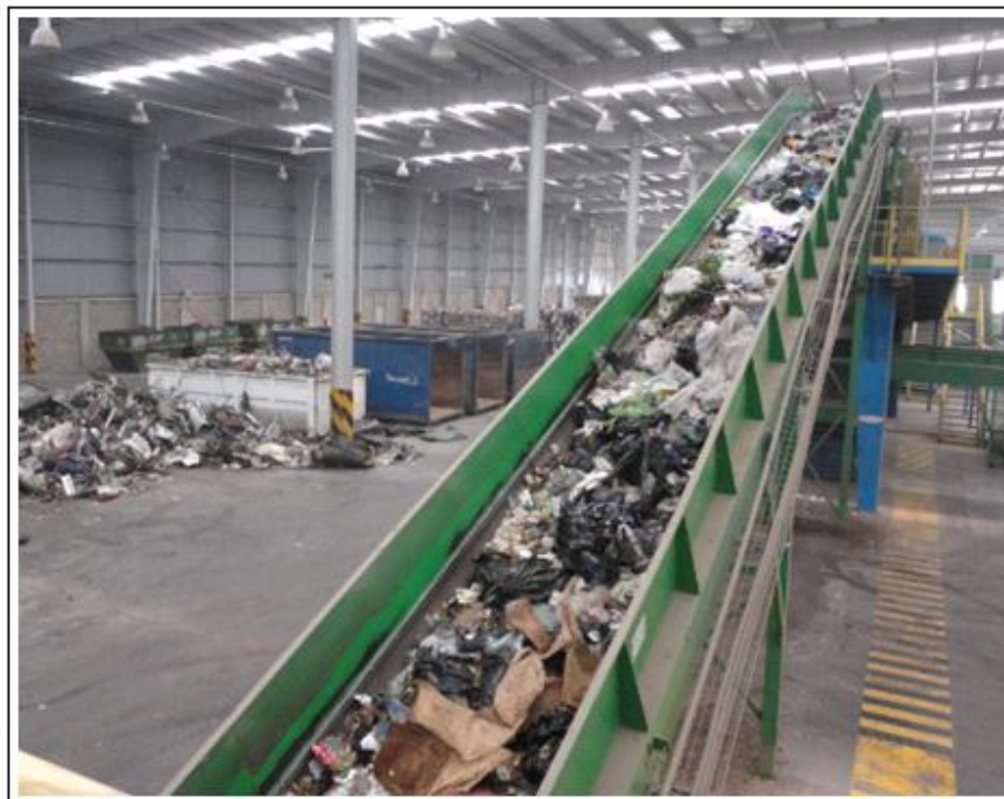
Figura 10: Cinta transportadora dirige los residuos hacia el tromel.
