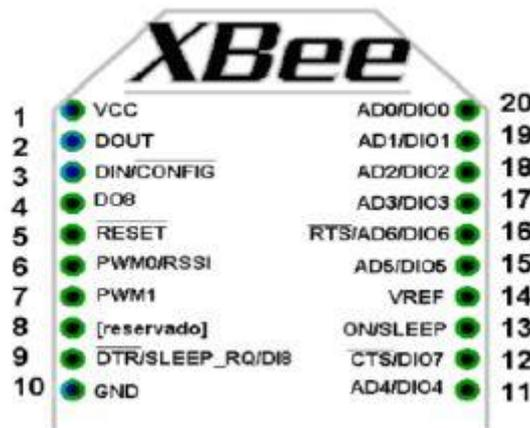
Figura 16: Diagrama esquemático del módulo *Xbee*
