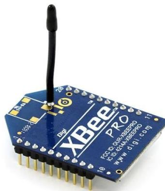
Figura 13: Módulo *Xbee* PRO
