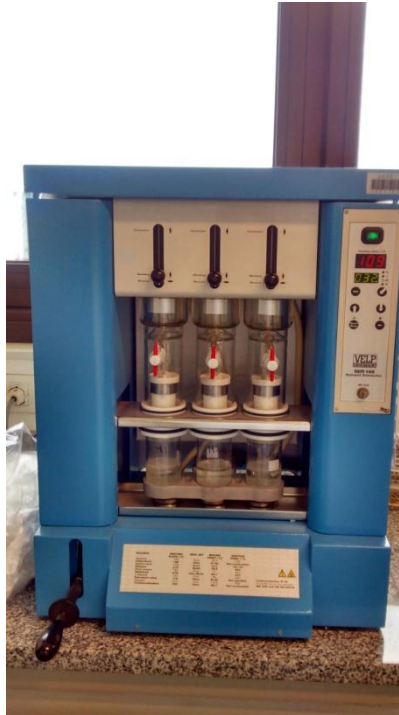
Figura 23: Equipo automático para obtención de grasas
