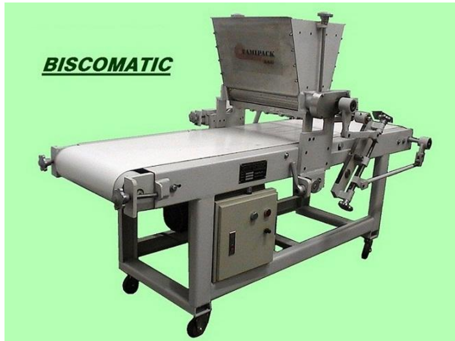
Figura 13: Modelo de máquina inyectora de galletas (FAMIPACK S.A.C., http://www.famipack.com )
