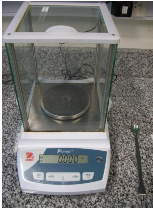
Figura 21: Balanza OHAUS Pioneer precisión 0,1 g
