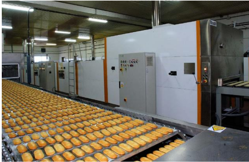
Figura 14: Modelo de Horno continuo de cocción. (TERMOPAN S.A, http://www.termopan.net )
