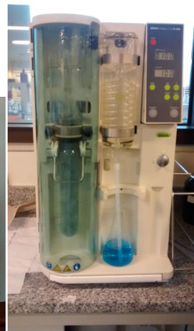
Figura 22: Equipo Kjeldahl automatizado para obtención de proteínas totales
