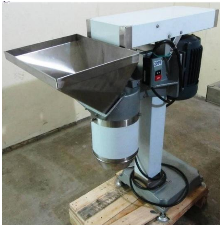
Figura 11: Modelo de trituradora automática de vegetales (Imarca C.A., www.imarca.com.ve )
