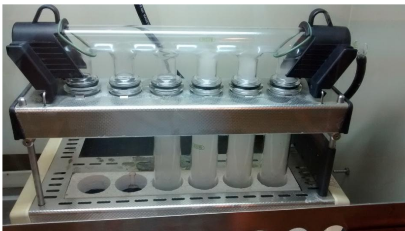
Figura 22: Equipo Kjeldahl automatizado para obtención de proteínas totales
