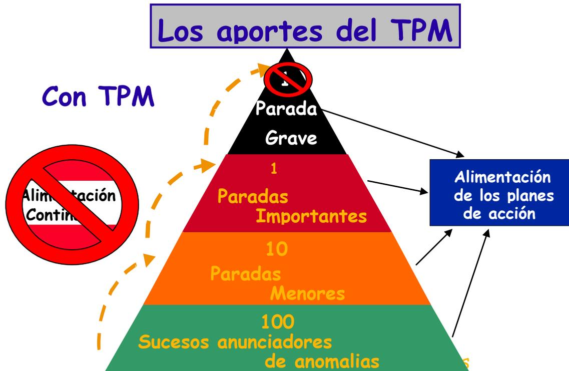
Figura 12: Pirámide de fallas con aplicación de TPM. Fuente: Manual de Procedimiento TPM PSA Peugeot - Citroen
