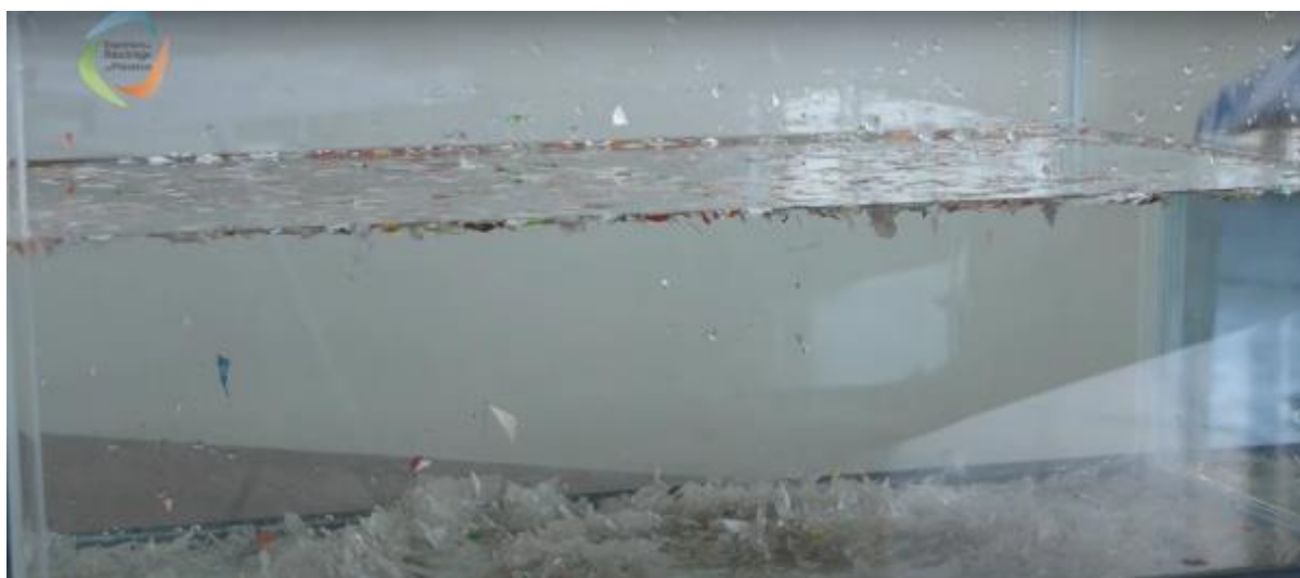
Figura 27: Separación del plástico mediante la diferencia de densidad.
