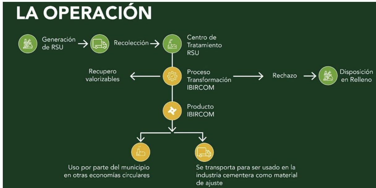
Figura 16: Operación completa del proceso IBIRCOM
