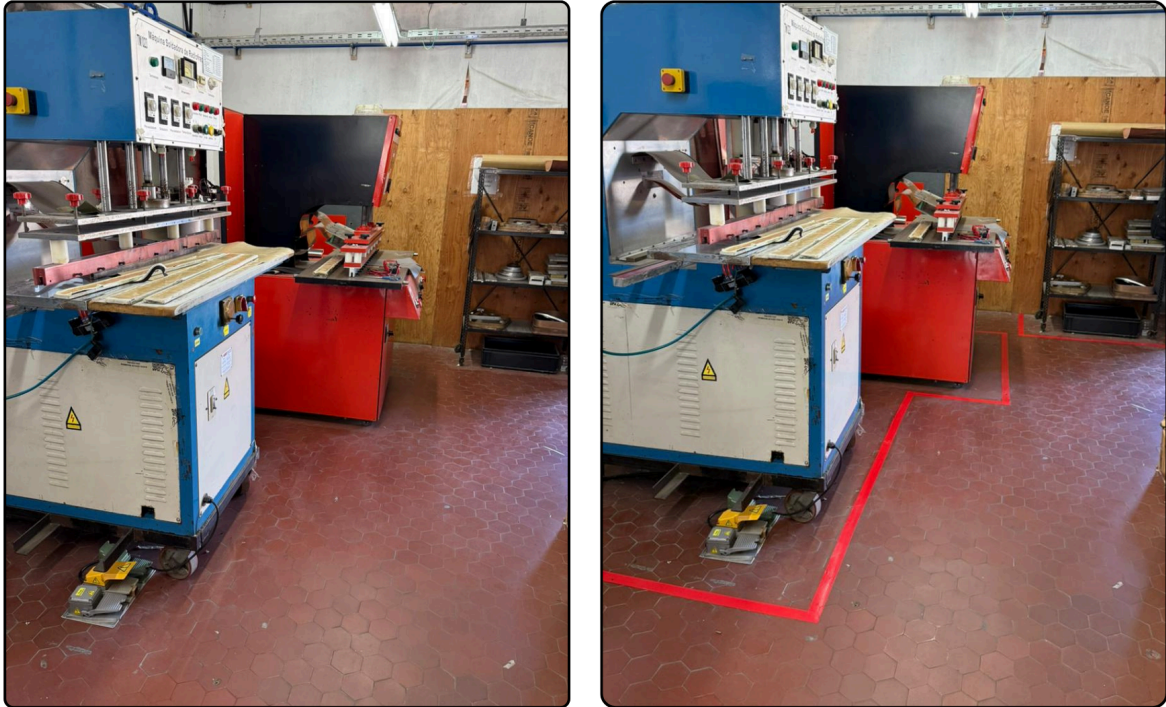
Figura 59. Demarcación de áreas y señalización operativa en planta.
