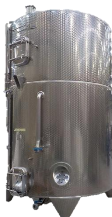
Figura XXIV. Tanque de ecualización y neutralización
