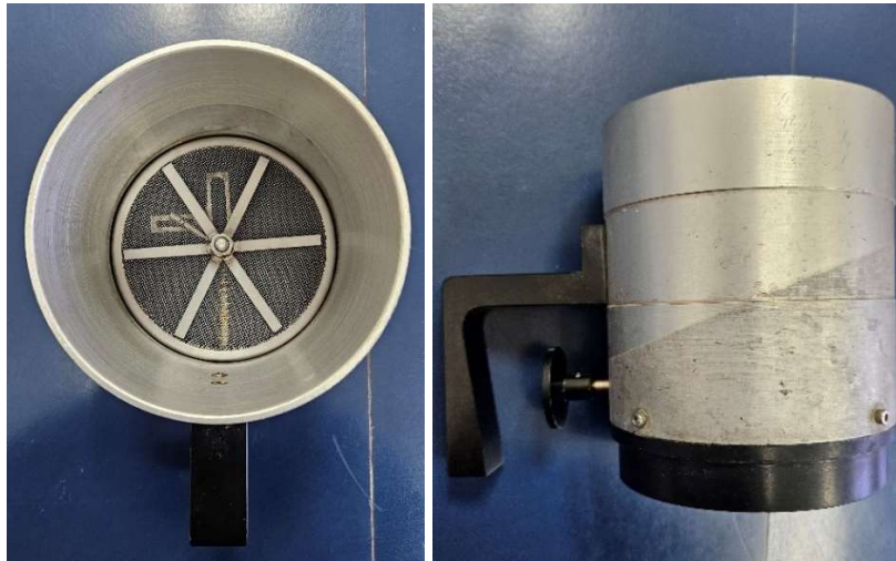
Figura 43: imagen de la izquierda, mecanismo central que regula el flujo del producto.
