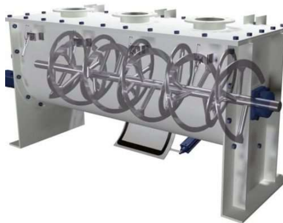
Figura 51: Mezcladora horizontal de cintas helicoidales. Las cintas, o espiras helicoidales, están montadas en sentidos opuestos sobre un mismo eje, lo que permite un mecanismo de avance en la mezcla. Imagen tomada de TOT Colombia (s.f.).
