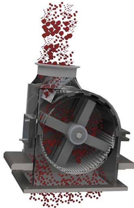
Figura 50: Esquema del molino de martillos utilizado para la molienda del café instantáneo. Imagen tomada de Molino de Martillos (s.f.).
