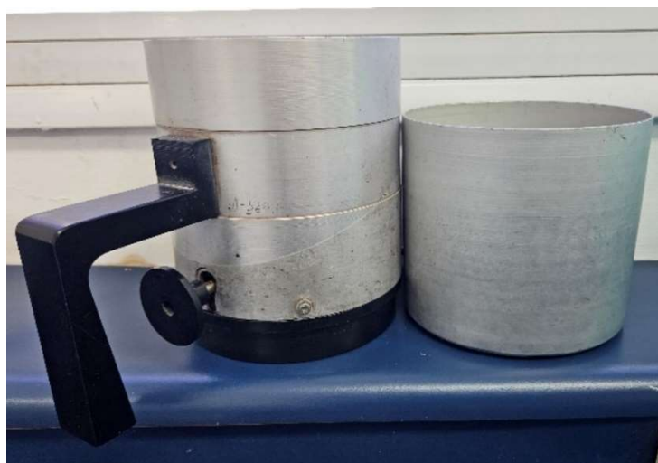
Figura 42: a la izquierda, recipiente superior; a la derecha, recipiente inferior del dispositivo medidor de fluidez.
