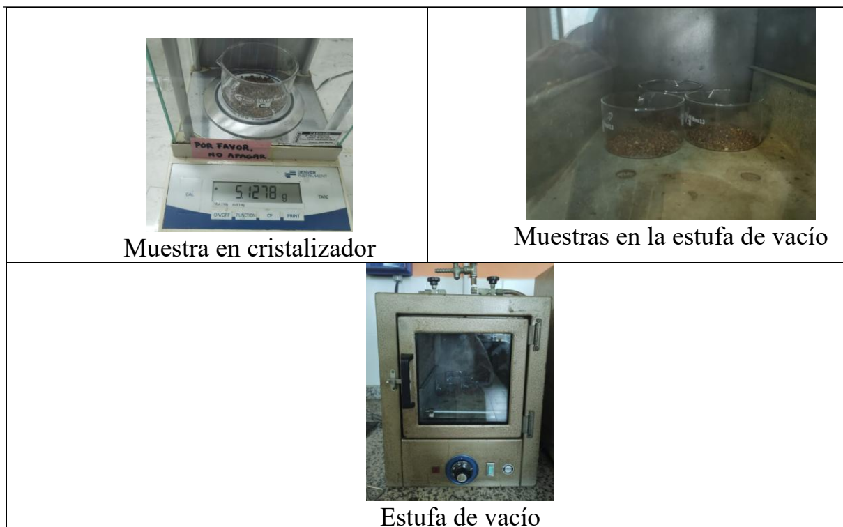
Ilustración 42 - Determinación de humedad. Fuente: propia
