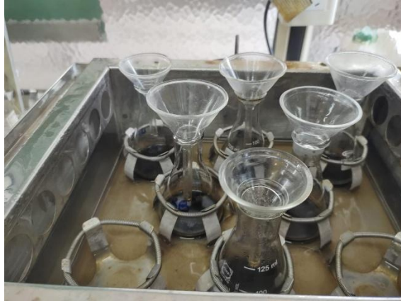
Ilustración 68 - Digestión de grasas: baño con agitación con etanol y ácido 7+3 con agua
