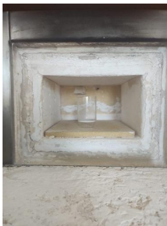
Ilustración 74 - Cápsula de corrección por cenizas en mufla: determinación de fibra. Fuente: propia
