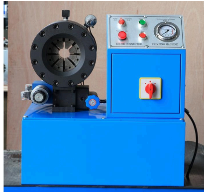
Figura 31: Prensa de tubos de acero YONG-FENG F16
