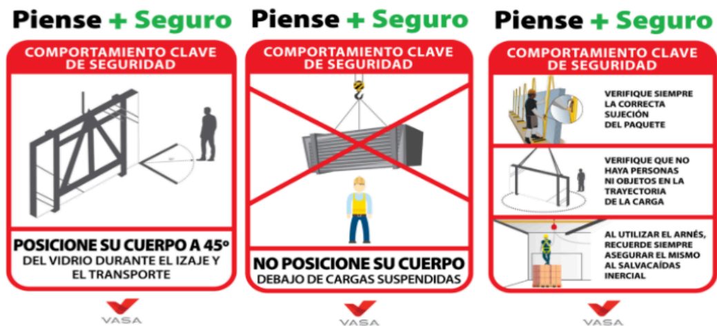
Figura 14: Señalización comportamiento de seguridad. Fuente: VASA.
