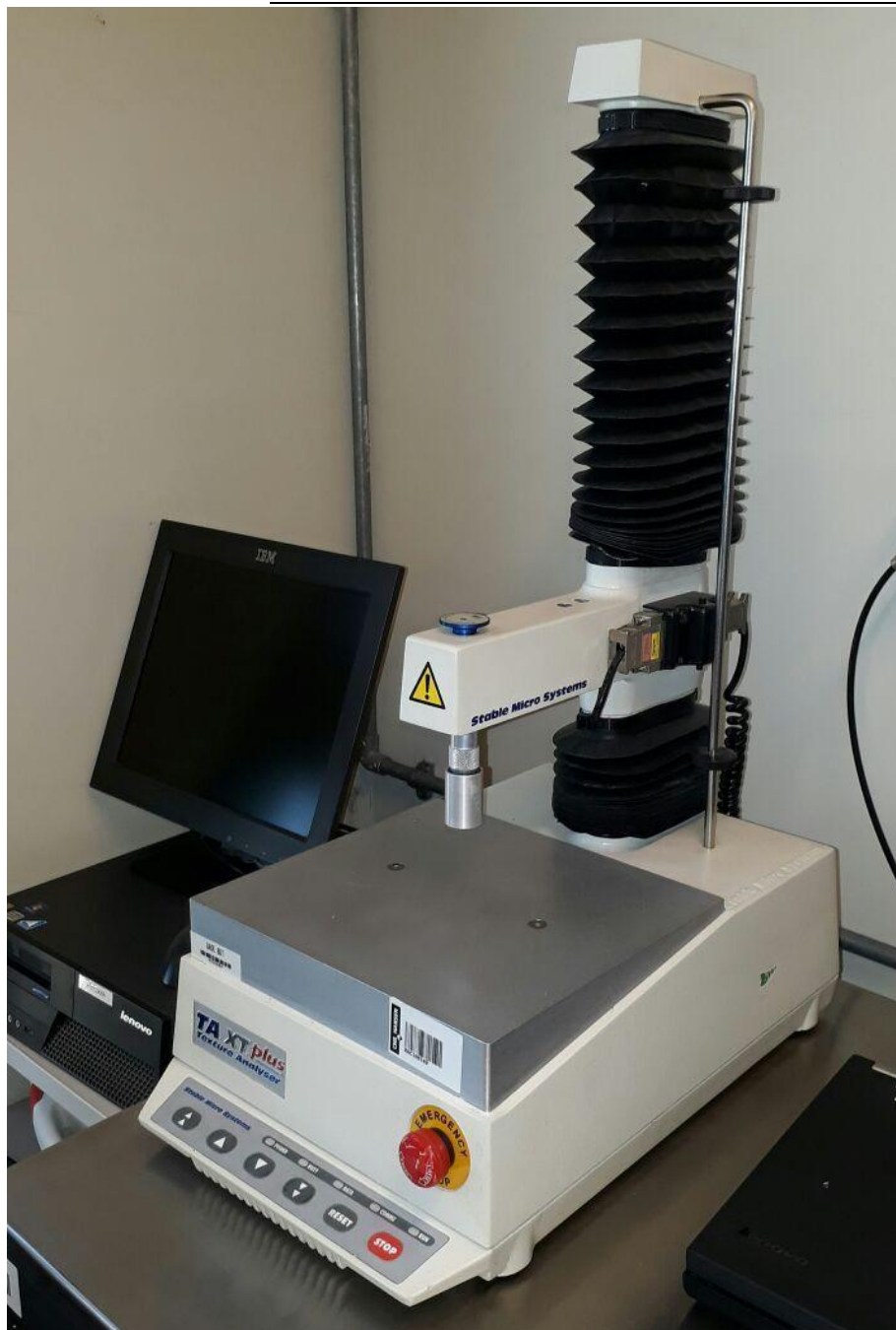
Figura 40: Texturómetro TA XT plus con sonda cilíndrica (a la derecha) y computadora con su software (a la izquierda).
