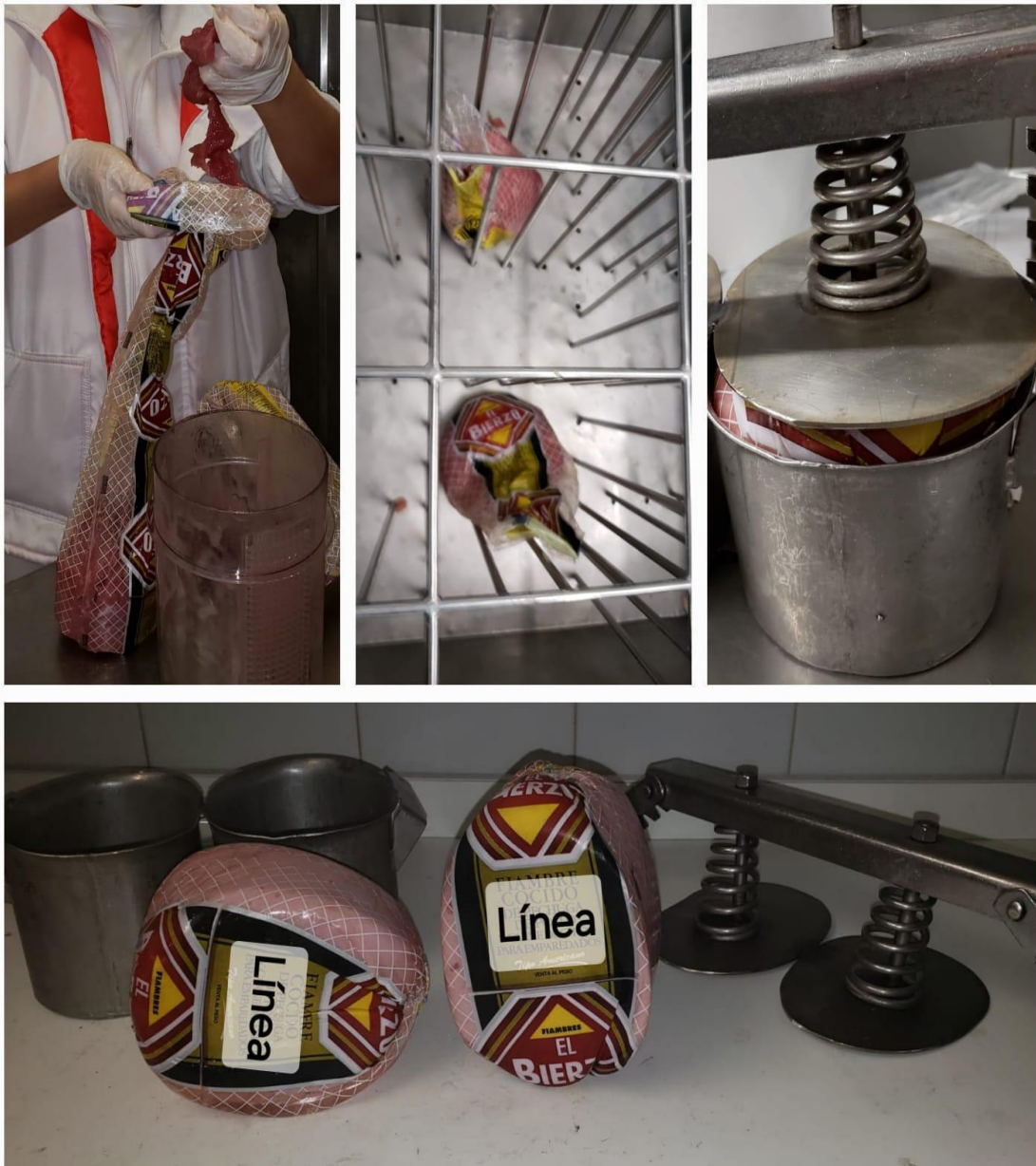
Figura 114: arriba a la izquierda: Embutición manual de la pieza cárnica curada dentro de la bolsa apta para cocción. arriba al medio: Aplicación de vacío antes de clipeado de bolsas para asegurar ausencia de aire interno. arriba a la derecha: Disposición de producto embutido en molde de acero inoxidable con tapa. abajo: Desmolde de producto luego de cocción y enfriado.
