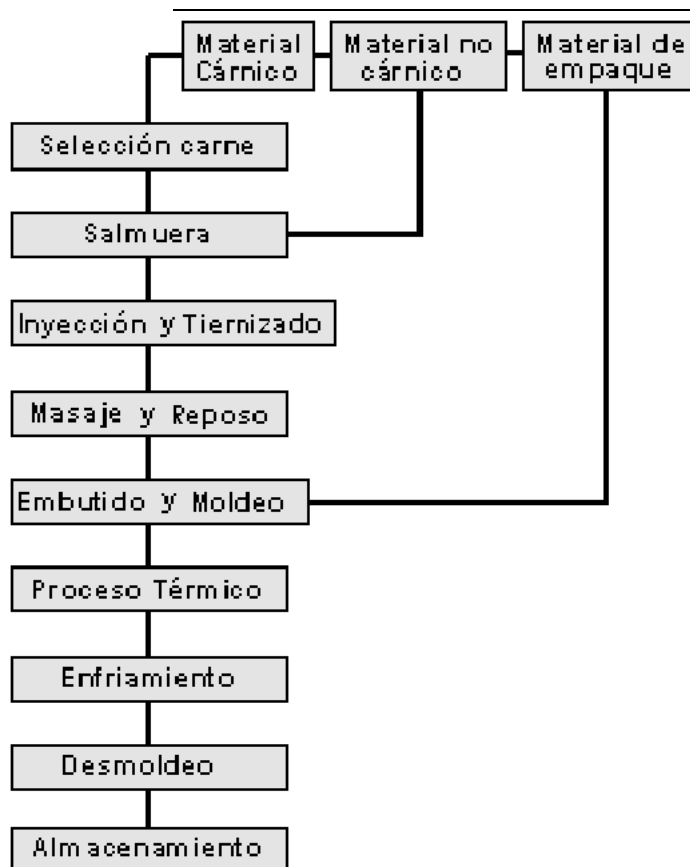
Figura 18: Diagrama de flujo de procesamiento industrial de Jamón cocido.
