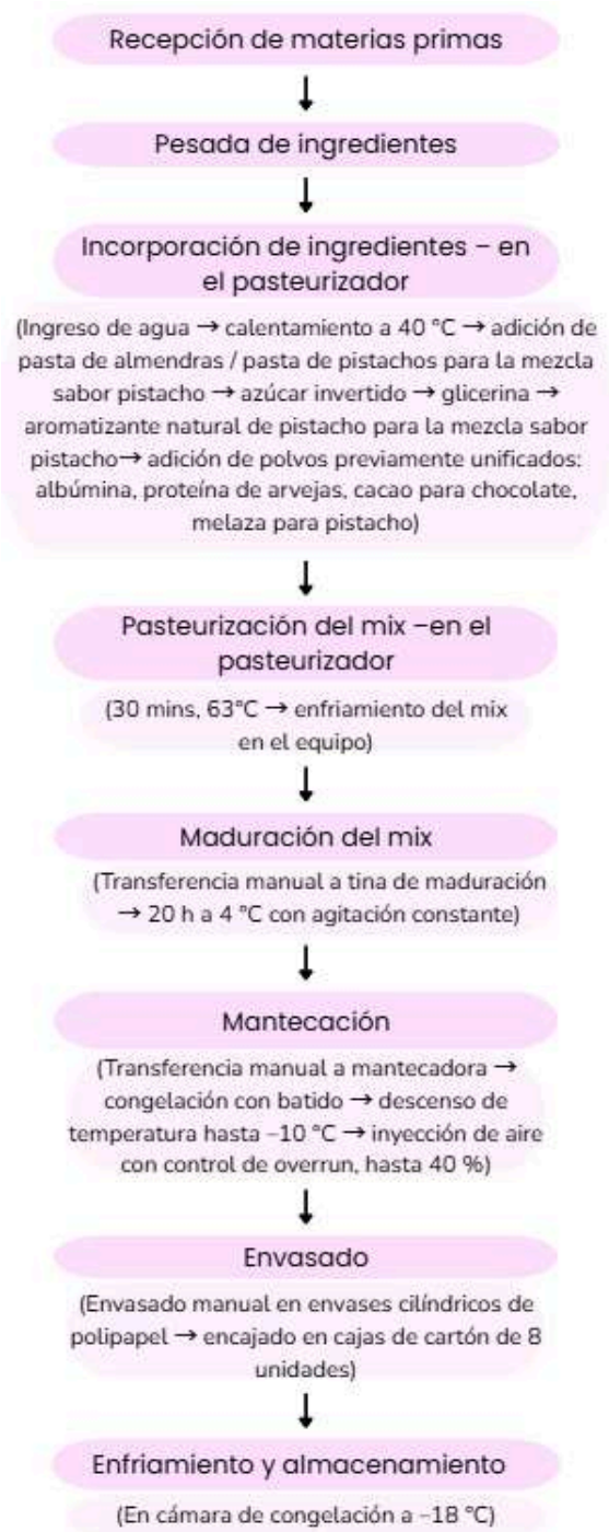
Figura 55: Diagrama de flujo específico para la producción a escala industrial en la planta diseñada con equipos usados. Fuente: Elaboración propia.
