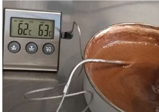
Figura 19: Mix durante la etapa de pasteurización, retirado de la fuente de calor cuando se alcanzaron los 62°C, y por el retraso térmico continuó aumentando la temperatura del mix aún alejado del calor. Fuente: Elaboración propia.
