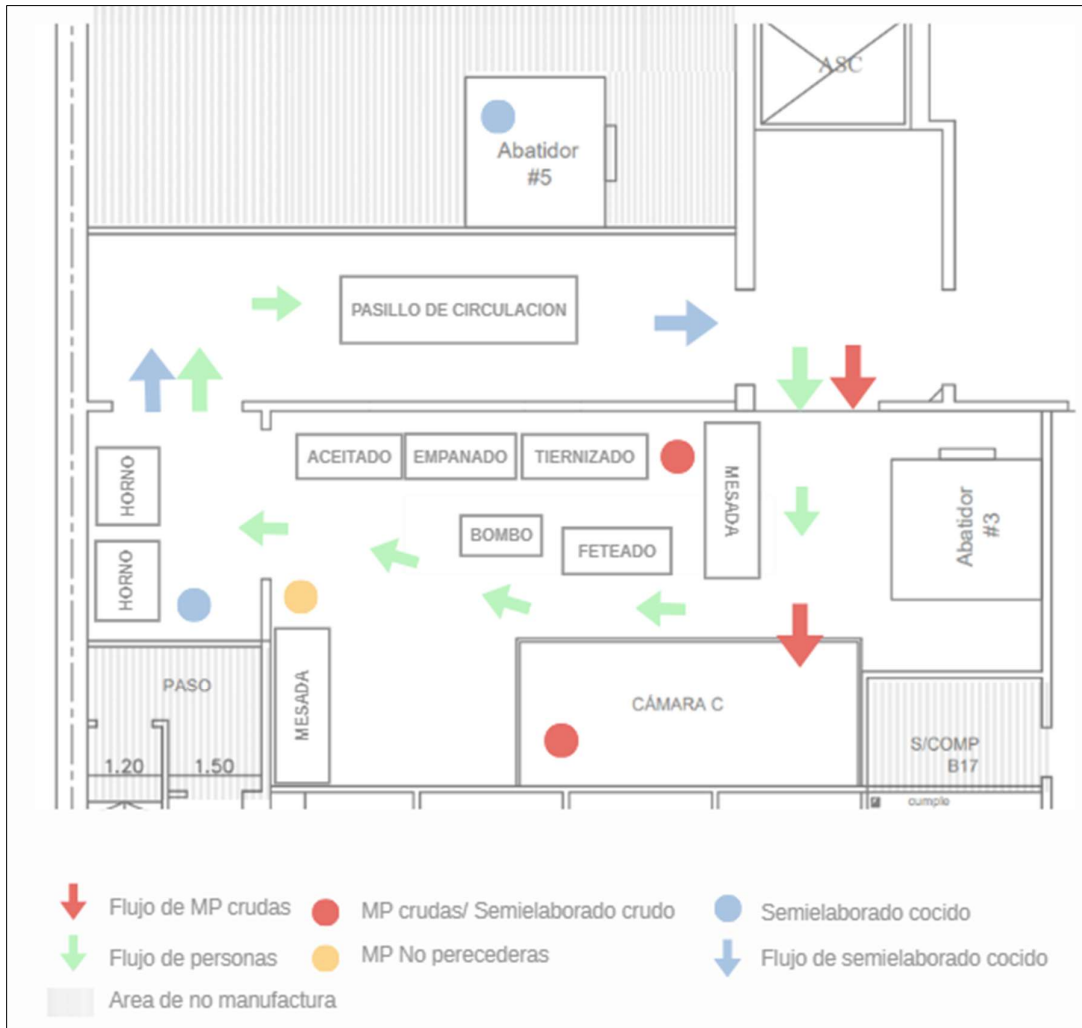
FIGURA 25: PLANO DEL SECTOR DE ELABORACIÓN DE MILANESAS CON REINGENIERÍA
