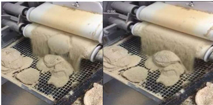
FIGURA 13: OBSERVACIÓN DEL PROCESO - CAÍDA DE LAS MILANESAS EN LA EMPANADORA
