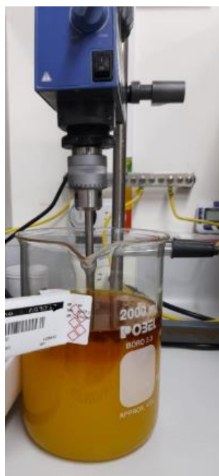
Figura 23: Agitación de producto wash 5 minutos y a 200 rpm de velocidad. Fuente: Anier S.A. - Buenos Aires - Argentina.
