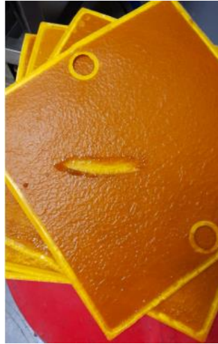
Figura 30: Muestra de resinas en placa de celulosa. Fuente: Anier S.A. - Buenos Aires - Argentina.
