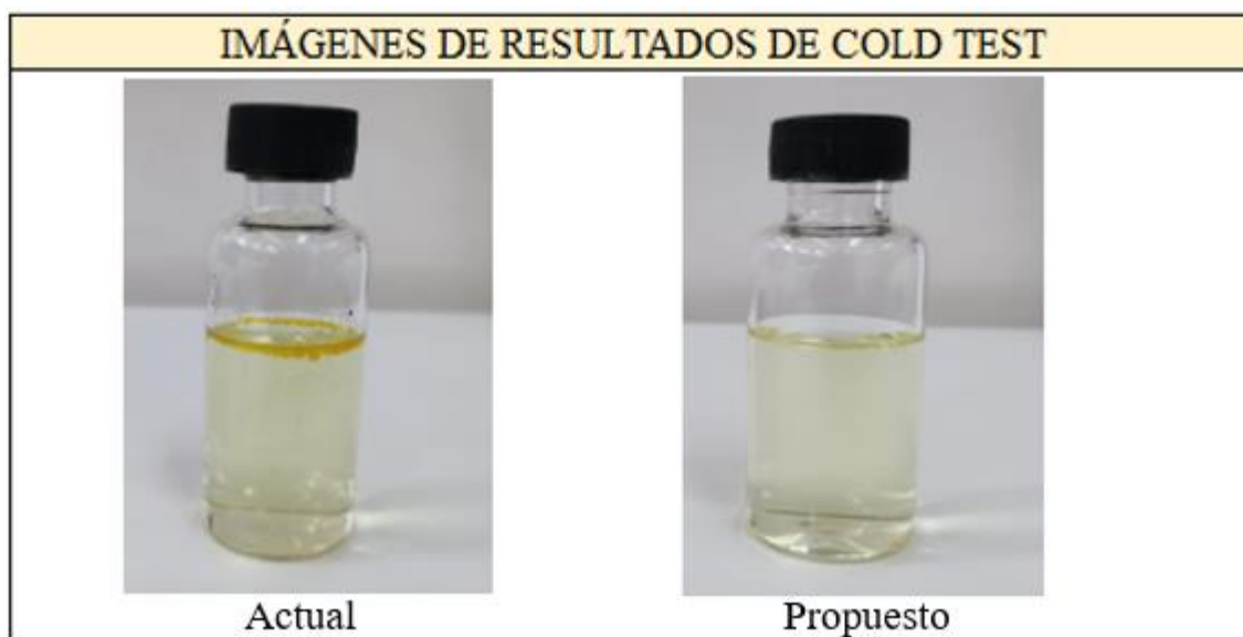
Figura 27: Resultados de cold test de método actual vs propuesto. Fuente: Anier S.A. - Buenos Aires - Argentina.
