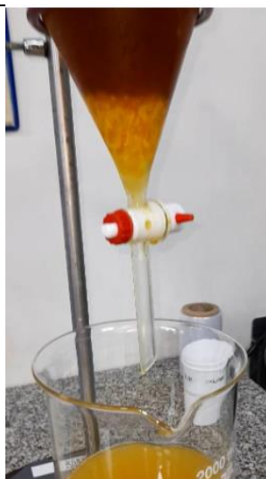
Figura 25: Decantación y separación de fases. Fuente: Anier S.A. - Buenos Aires - Argentina.
