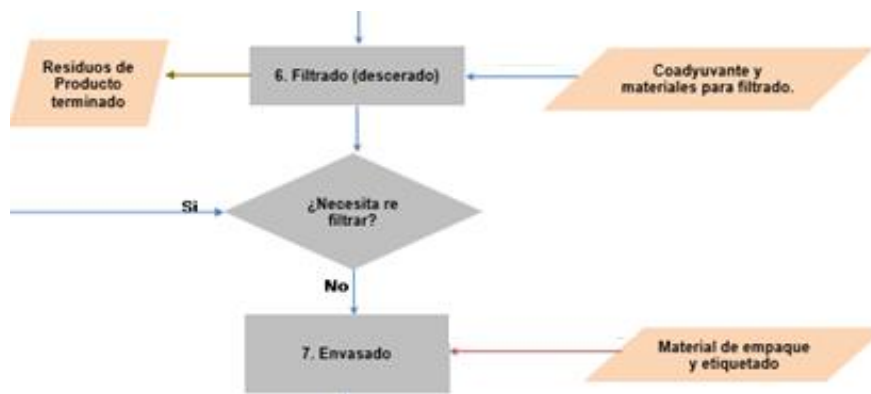
Figura 8E: Flujograma de proceso. Fuente: Anier S.A. - Buenos Aires - Argentina.
