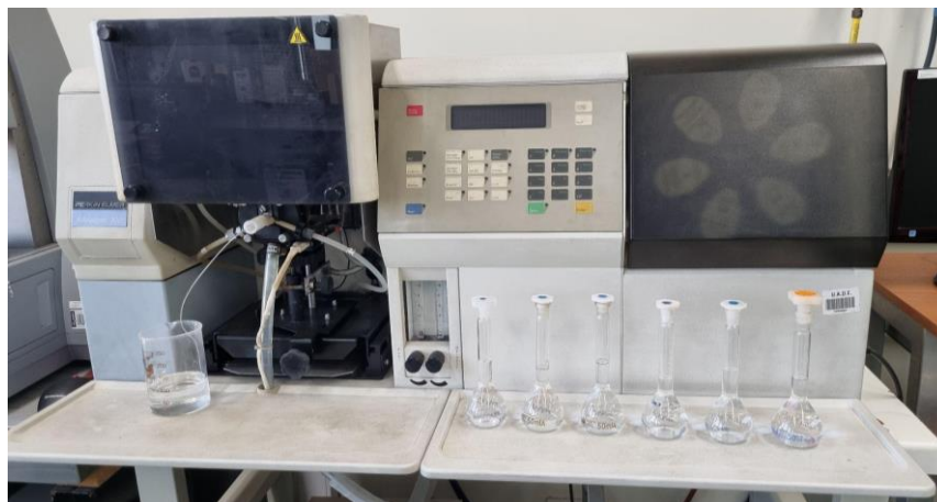
Figura 50: Espectrofotómetro de absorción atómica Perkin Elmer AAnalyst 100 utilizado.
