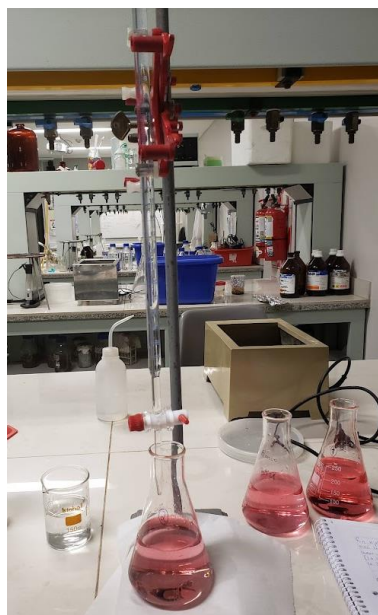
Figura 55: Muestra N°2 tras ser titulada con HCl, se observa un viraje de color verde a rojo.
