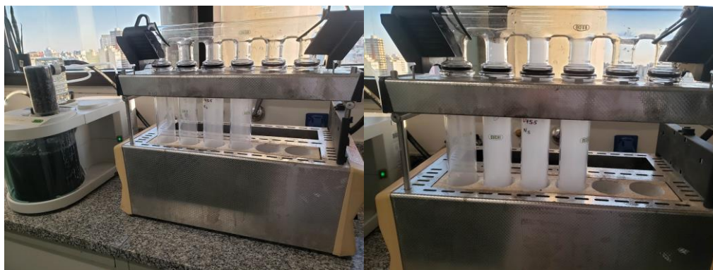
Figura 53: Proceso de digestión de las muestras (Blanco, Muestra 1, 2 y 3).
