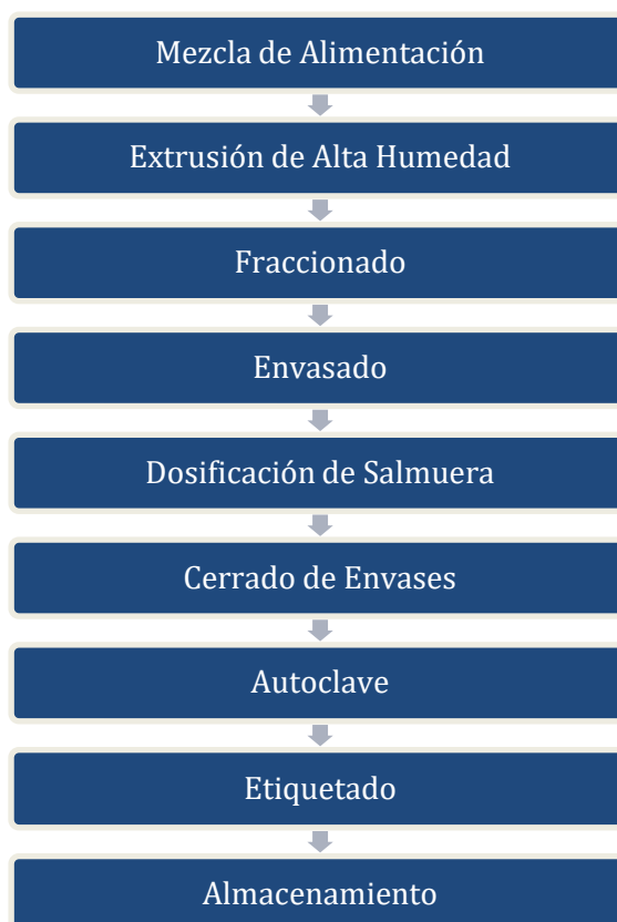
Figura 39: diagrama del proceso de producción propuesto. Fuente: elaboración propia.
