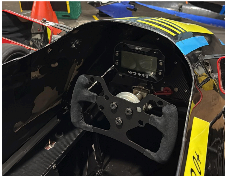
Figura 9: AIM Mychron 5 instalado en un auto de Fórmula 5 Metropolitana (Elaboración propia Mayo 2025)
