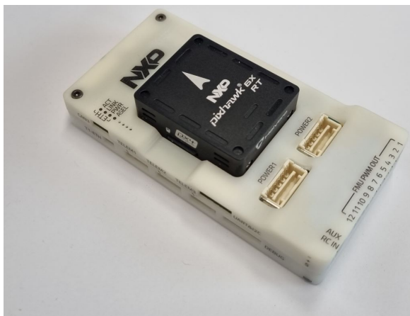
(a) Placa de control de vuelo NXP MR-VMU-RT1176, que soporta el firmware de PX4
