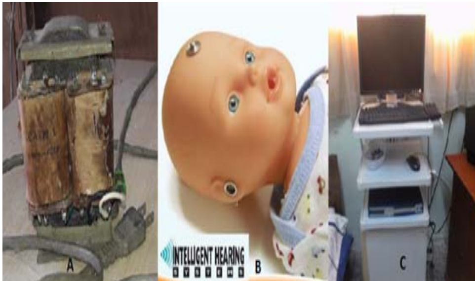
Fig.1. A: Generador de campo magnético construido a partir del transformador de televisor de tubo de rayos catódicos B: Simulador de señales auditivas C: Electroaudiómetro Audix V
