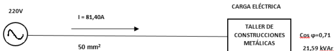
Figura 2: Alimentación eléctrica, sin compensar
